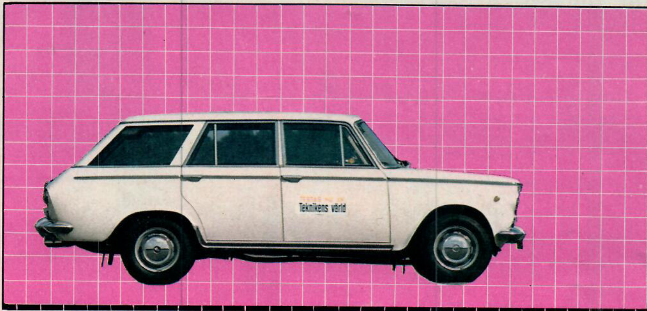
Bilen i skala 1:30. Varje ruta 20x20 cm. Totallängd 403 cm, hjulbas 242 cm, max. bredd 155 cm, höjd 142 cm.
