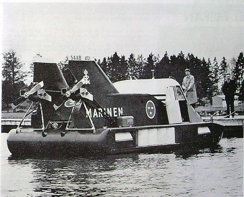
Närbild av svävaren snett bakifrån med driv och girportar väl synliga.
