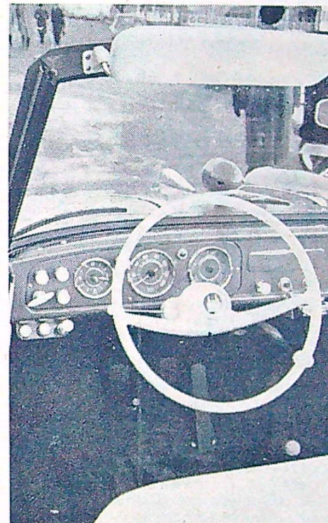
Instrumentpanelen är utformad som på en vanlig småbil och det enda ovanliga i interiören är spaken för inkoppling av propellrarna.
