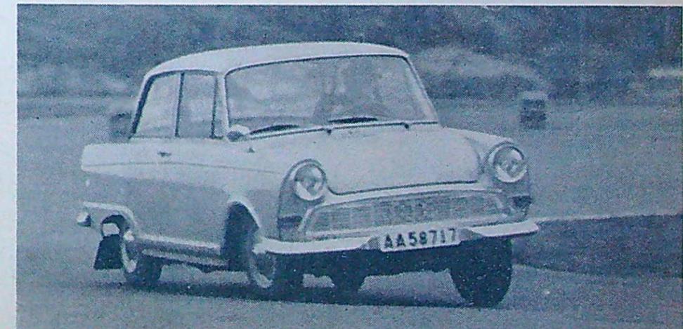
F 12 är en mycket pigg bil. Den är utrustad med en 45 hästars tvåtaktsmotor. Växellådan är helsynkroniserad med fyra framtåglägen. Accelerationssiffrorna är hyfsade: 0—80 km/tim tar omkring 12 sekunder.
