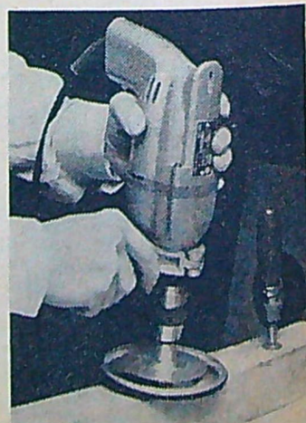
Rondellen i arbete. Det gäller att hålla rätt vinkel hela tiden och detta underlättas om maskinen har stödhandtag.
