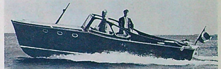
SOLO 7,25x2,25 m. Ruffbåt med 2 kojplatser och pentry. Motor: Volvo Penta BB 70, fart c:a 16 knop. SOLO finns också i byggsats.
