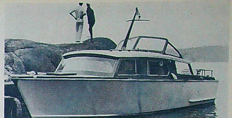
STORÖ 8,55x2,80 m. Motorkryssare med 4 kojplatser, pentry, wc m m. Motorer: 2 st Volvo Penta BB 100, fart c:a 22 knop.
