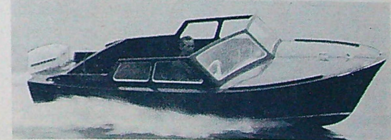
FALKEN 5,10x1,95 m. Rymlig elegant campingbåt. Passande motorer: Scott 28 och 45 hk, fart c:a 18 resp 25 knop.
