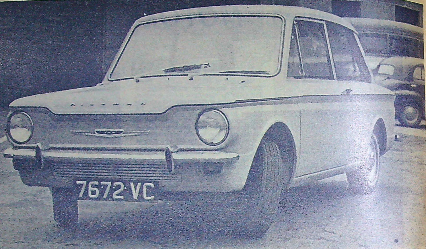
Hillman Imp är en liten intressant vagn med utmärkta vägegenskaper. Trots svansmotor är den inte överstyrd. Oljebyte behöver bara ske var 800:e mil.
