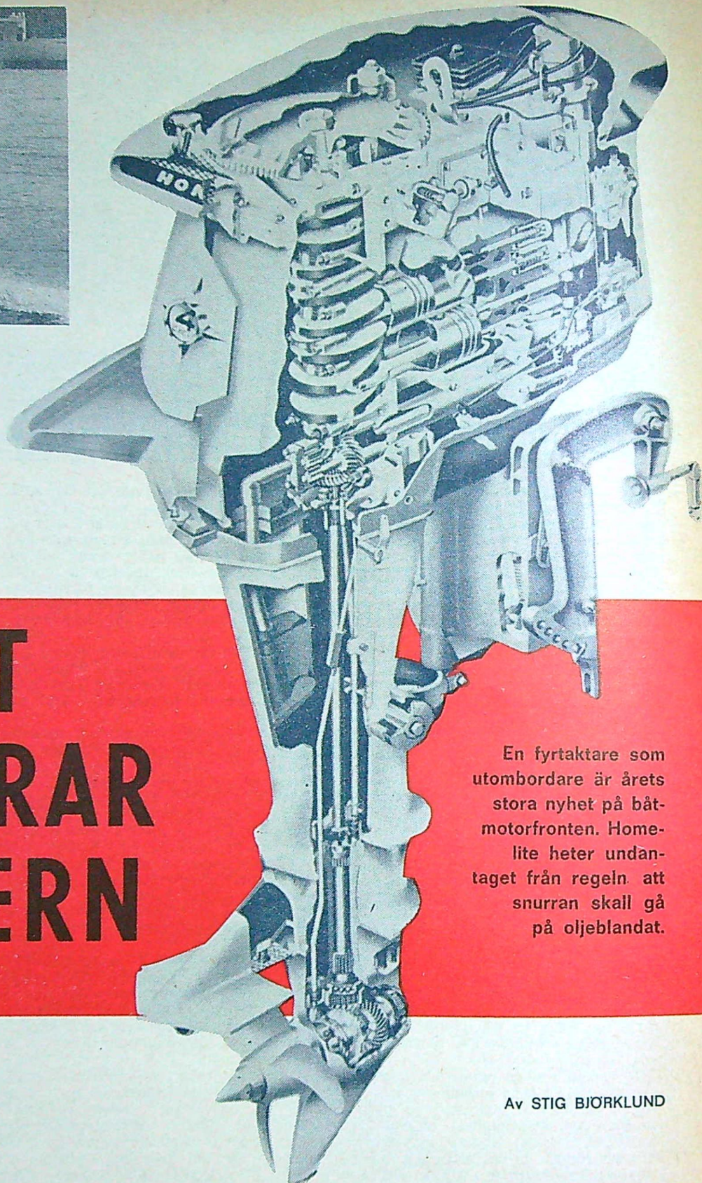
Den första utombordsfyrtaktaren är som synes ganska konventionell exteriormässigt sett. Här i aktern på norska Fjord Cruiser. Teckningen tillger en god uppfattning om vad som skiljer den från genomsnittet, nämligen ventilerna.
