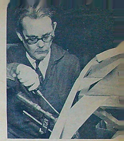
5 När slagvägarna skall böjas in mot fören har man god hjälp av ett par verkligt robusta tvingar.
