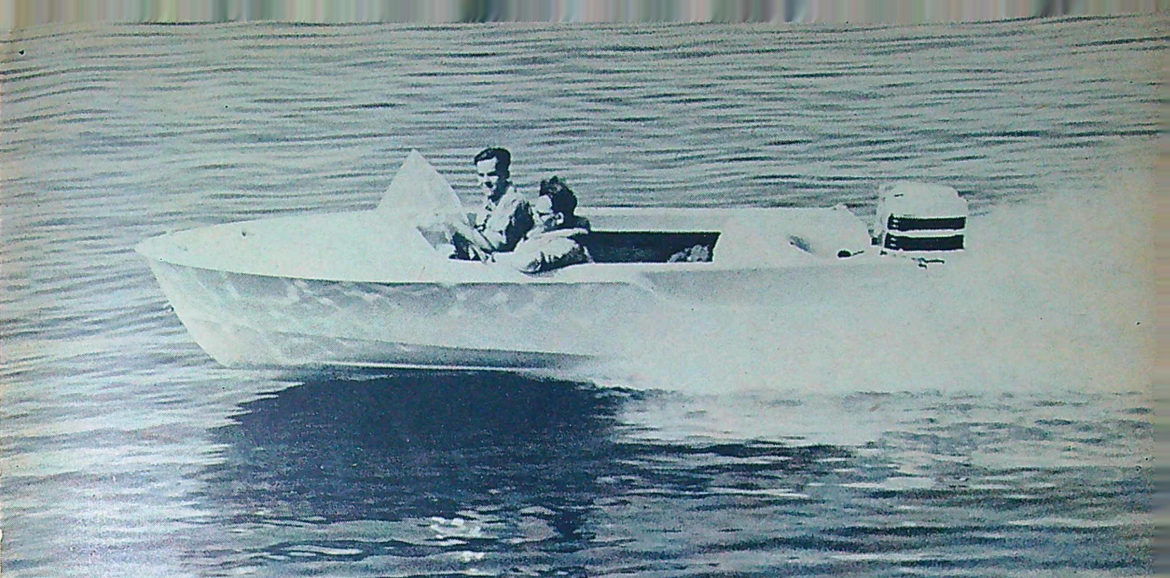
Riviera har en mycket elegant gång med lågt liggande för. Avvisarkanten längs slaget slår undan vattnet och färdens blir därför "torr" även i hög fart. Finishen är lækker med blänkande plastytor och fenderlisten av mjukplast skyddar effektivt vid angöring av bryggor.
