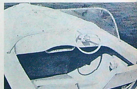
"Handskfacket" under rattbrädan är så väl tilltaget att där även finns plats för sjökort. Under fördäcket finns det ett väl tilltaget stuvningsutrymme.
