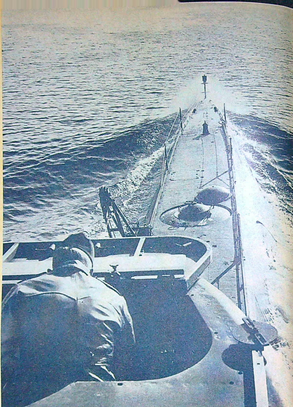
Gripen styr till havs. Nedanför tornet ses förluckan, som även har anslutningsanordningar för ubåtsbäringsfartyget Belos räddningsklocka. Klockan kan anslutas till luckan och gör det möjligt att bärga besättningsmännen i en sjunken ubåt. Till utrustningen hör också den telefonboj, som i ett nödläge stiger upp till ytan och som möjliggör kontakt med och lokalisering av en förolyckad ubåt.
