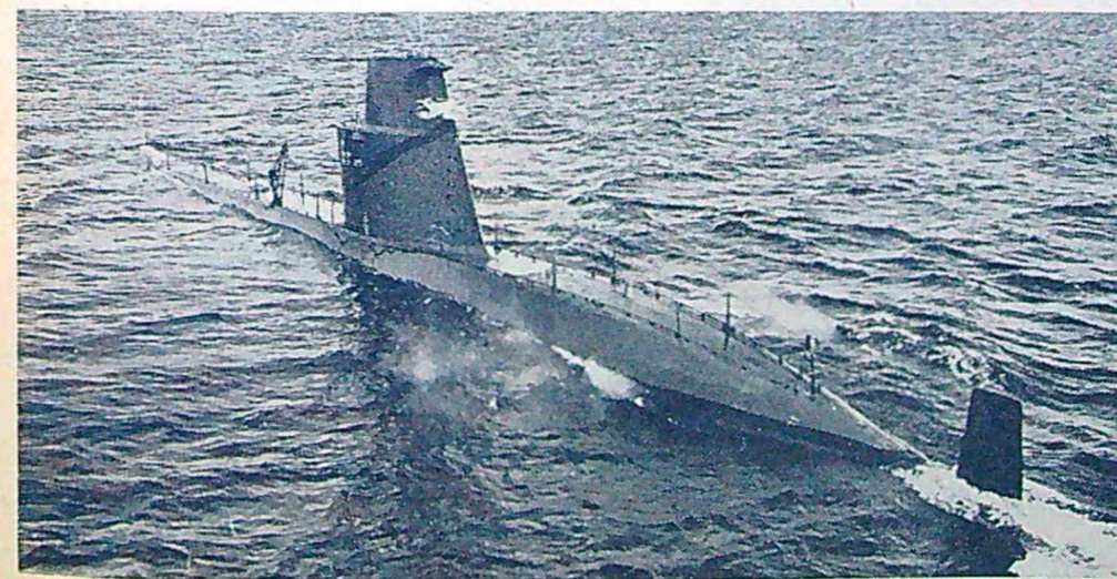
Gripen är en av flottans modernaste ubåtar och tillhör den moderniserade Hajen-klassen. Den drivs dock med elmotor, som får sin kraft från dieselmotorladdade batterier.
