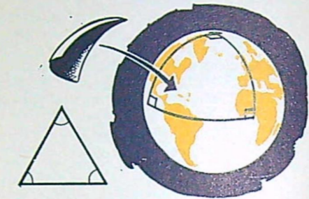
På ett plant papper är summan av en triangelns vinklar alltid 180°. På jordytan (eller en klotyta) är vinkelsumman alltid större än 180°, t ex 270° som på figuren.
