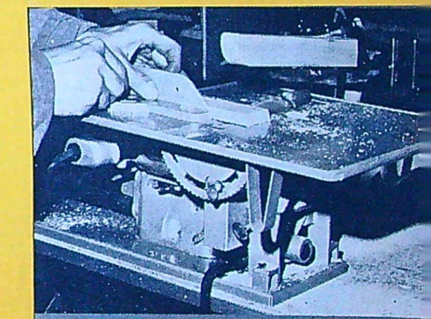
Kombinerad som rondellslip medger grundsatsen med hjälp av anhållet noggrann slipning av olika vinklar i två riktningar.
