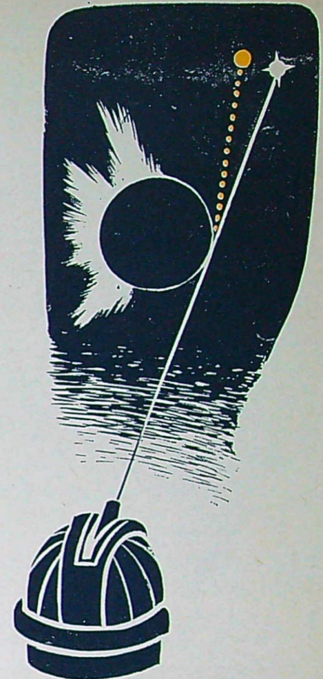
I närheten av solen påverkas ljuset av solens tyngdkraft. Vid solförmörkelser kan man se stjärnor nära solens rand. Man kan då mäta hur mycket deras ljus avböjs när det passerar solen.
