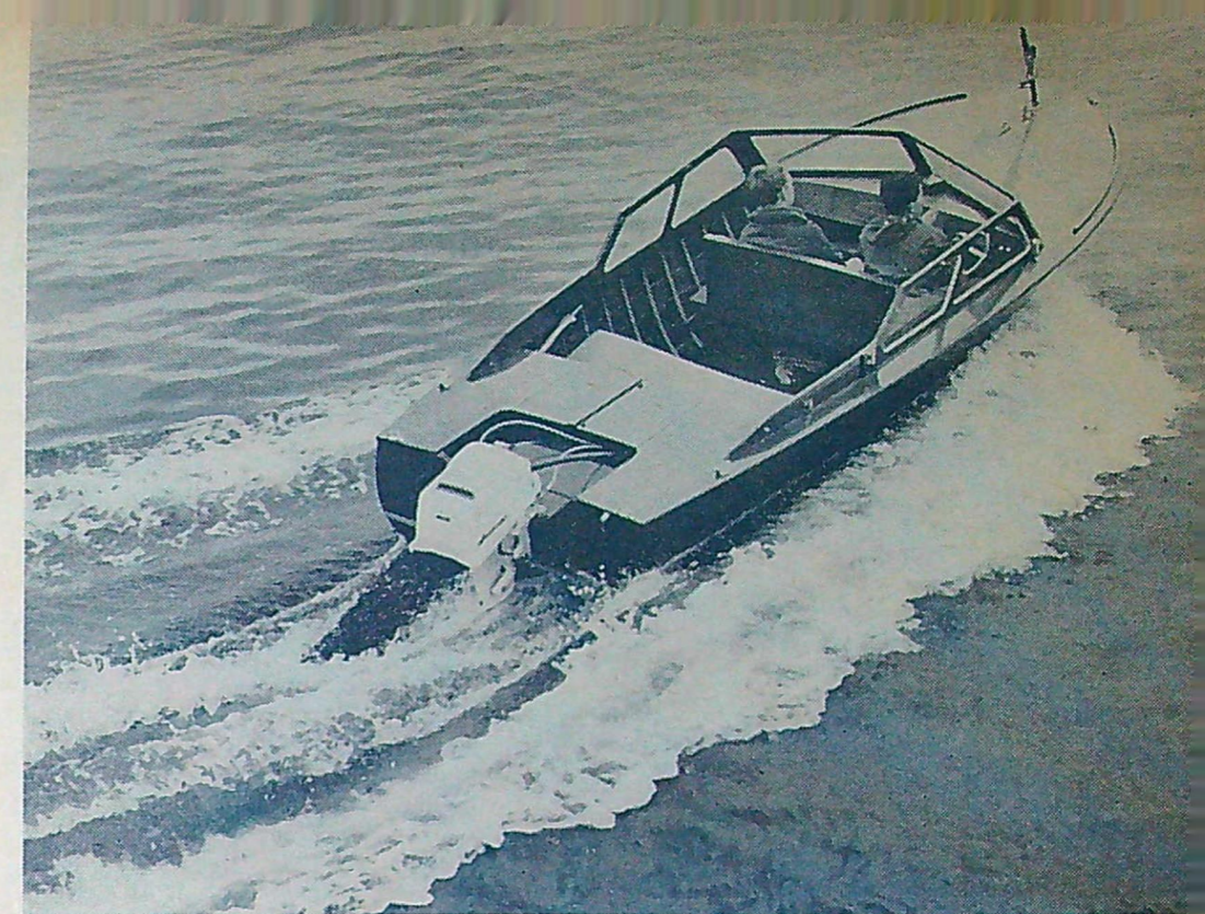
Lux Camping Holiday är en trivsamt båt, som tillverkats enligt gammal god båtbyggartradition. Utrymmena ombord är väl tillvaratagna och inredningen ger ett intryck av att vara genomtänkt. Den öppningsbara vindrutan har breda sidogavlar, som ger ett utmärkt skydd mot vind och vattenstänk.
