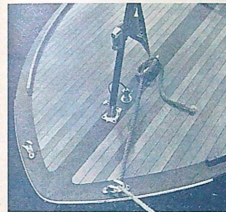
En bogskena skyddar relingslisten vid stäven. Däcket är utfört i Oregon Pine och mahogny och alla skruvhål är ordentligt proppade.
