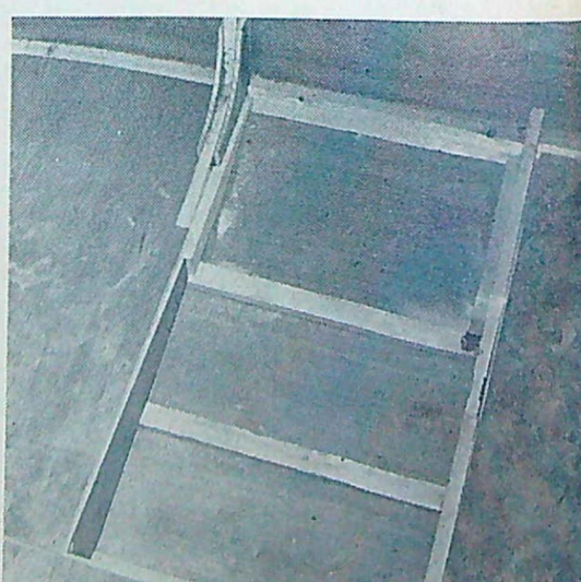
8 Durkarna passas in. Av de sex durkarna i aktersittbrunnen har en plockats bort för att visa placeringen av durkvägarna.
