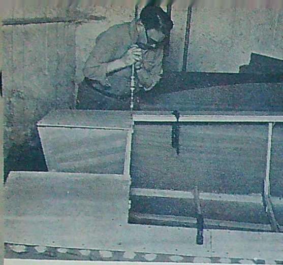
1 Akterdäcket skruvas fast. Detta skarvas till skarndäcket med hjälp av skarvklappar som här hålls fast med hjälp av ett par robusta tvingar.
