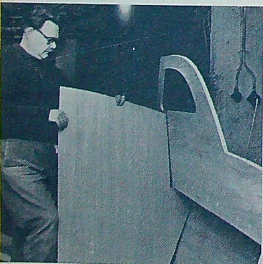
6 Den första kabinskottshalvan passas in mot bordläggning och sarg. Den skruvas och limmas sedan mot spanten.
