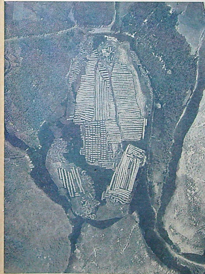
Varje liten bunt i detta timmermagasin innehåller 15—20 m 3 . Man har bara att på fotot räkna och pricka av buntarna, vilket är gjort på en halvtimme. Tidigare behövde en man en vecka för att göra motsvarande beräkning.
