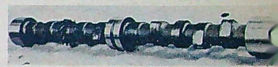
Kammens utformning medger åtskillig slipning och kan bli en fin Börserkam.
