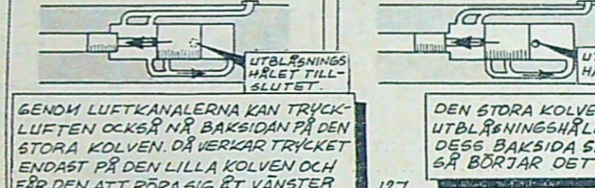
LUFTEN UTÖVAR DET STÖRSTA TRYCKET PÅ DEN STORA KOLVEN SOM DÄRFÖR PRESSAS ÅT HÖGER.
