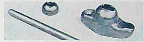
De lätta vipparms- och lyftarstängdelarna som saknar en tyngande ventiljustering.
