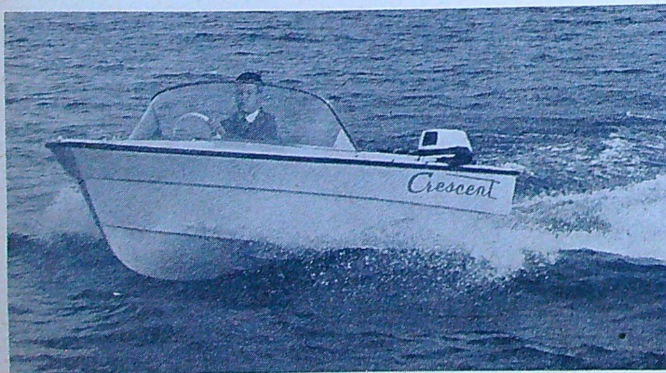
Crescent-Monarks nya sportbåt har konstruerats av ingenjör Harry Becker och har skarp V-botten med markerade skidlinjer. Längden är 4,27 m och bredden 1,60 m. Båten kan ta upp till fem personer och lämpar sig för motorer på upp till 30 hk. Samma skrov finns också i odäckad version som familje- och fläskbåt.
