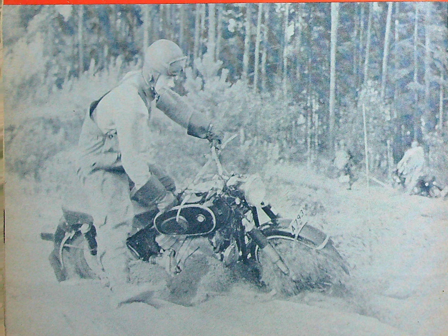
Motorcykeln som grävmaskin, eller vad? Den över 200 kg tunga cykeln har borrarat ned sig ordentligt i den lösa sanden, och det blir ingen lätt sak att få upp den. Att försöka dra upp cykeln med motorn är ingen idé, det enda är att kliva av höjen, ta ett bastant tag i bakstegen och lyfta den ur spåret.
