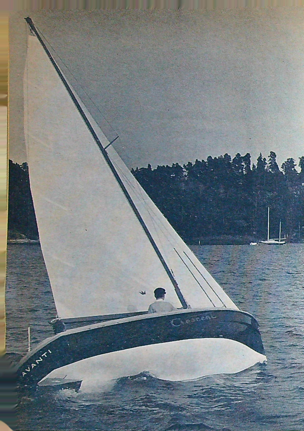
Avanti har mastheadrigg och mast i fiberglas. Båten är helt byggd i plast med durk av mahogny och fotlister av teak. Akterns utformning ger snabb gång genom att vattnet lättare släpper och att baksug förhindras.
