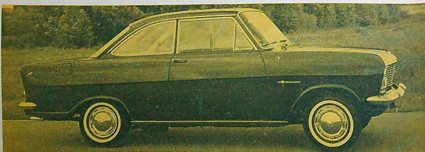
Utmärkande för Kadett Coupé är den svepande taklinjen och bakpartiet som skiljer sig från Kadett Sedan och Caravan 1000. Enlittermotorn ger 54 hk. Toppfarten är ca 135 km/tim, acceleration 0—100 km/tim ca 19,5 sek. Inredningen har samma utformning som i Kadett Sedan. Priset är ännu inte bekant.
