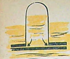
Fig 3. Bestämning av viskositeten genom att låta vätskan flyta ut mellan två plana skivor på litet avstånd från varandra. Försöket ger mycket lågt värde på viskositeten.
