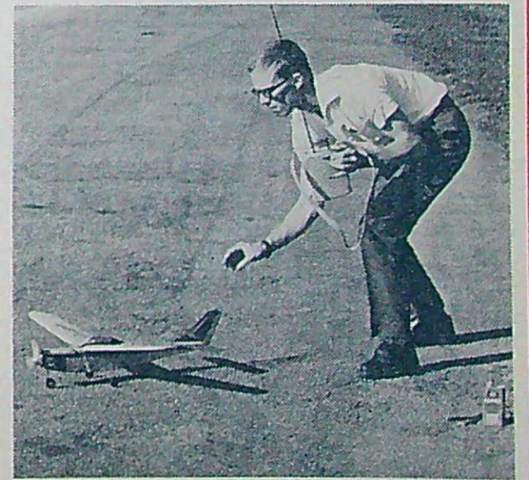
Modellen börjar sätta fart över betongbanan. Den styrs med en Metzrekanalsändare och två kanaler utnyttjas för sidorodermanövreringen.
