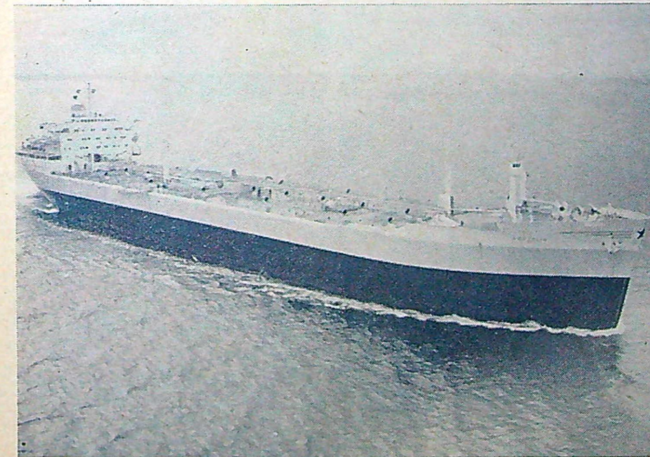
Kockums Mekaniska Verkstad har levererat motortanken "Vestalis" på 60 050 ton dw till Smedvigs Tankrederi A/S, Stavanger. MT "Vestalls" är Norges (och Skandinaviens) största fartyg. För att förbättra styrkeförhållanden och reducera vibrationerna i akterskeppet till ett minimum har lastdelens båda långskeppskott dragits akteröver genom maskinrummet i hela dess längd.
