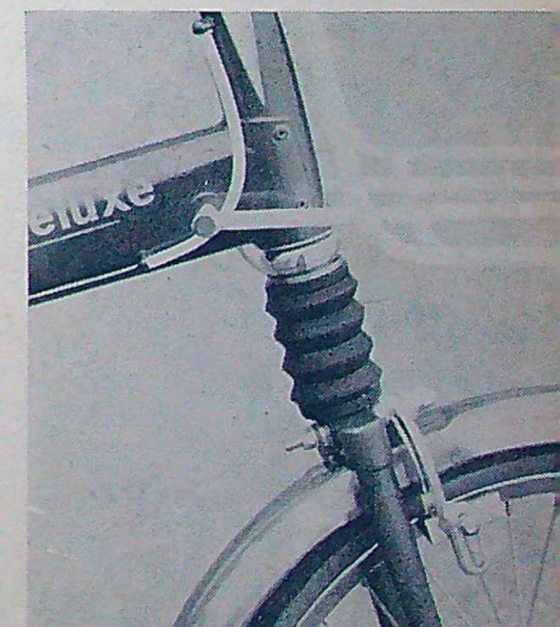
Det är Alex Moulton — mannen bakom Morris 1100:s nya hydraulgummifjädring med vätskeutjämning — som konstruerat cykelns gummifjädring.
