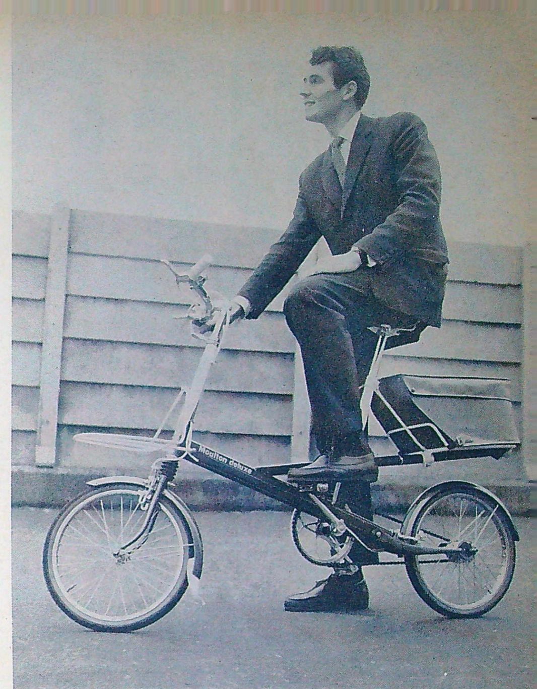
Moulton deluxe är inte lik andra cyklar. Här har man nämligen utnyttjat erfarenheterna från skotrar och bilfjädring och resultatet har blivit en mjukt framglidande tvåhjulning. En effektiv fjädring gör att ojämnheter i vägbanan inte märks, och de små hjulen, som bara mäter 40 cm i diameter, ger en låg tyngdpunkt.
