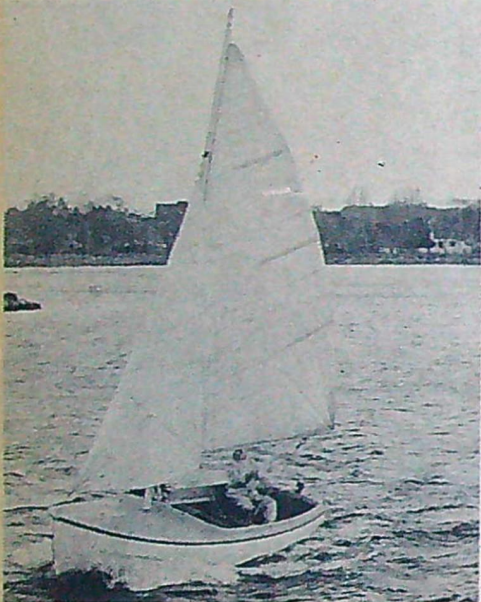
Segeljollen Torekov tillverkas av Malmö Flygindustri, mäter 5,40 x 1,85 m och kan föra 12 kvadratmeters segel. 7 900 kr.
