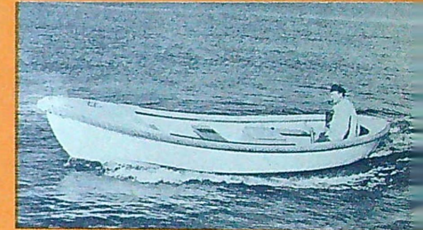
Fiskenippan Rivö förs bl. a. av Hansson & Lundbom Motor AB i Göteborg. Den är utförd i plast, 5,50 m lång, 1,90 m bred och utrustad med Volvo Penta C 23 F för fotogendrift. Gör 7 knop. Pris 9 950 kr.
