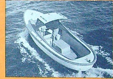
Från Bro varv kommer också denna robusta plastbåt, som bl. a. är tänkt som bruksbåt i hamnar etc. Den heter Hamnbjörn, mäter 6,70x2,30 m och är avsedd för 15-35 hk motor. Pris utan motor 20 000 kr.
