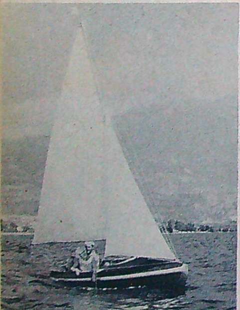
Detta är den monterbara Klepper Master i segelbåtsutförande. Segelytan är 6,6 m 2 . Klepper-agenturen. Priset är 2 100 kronor.
