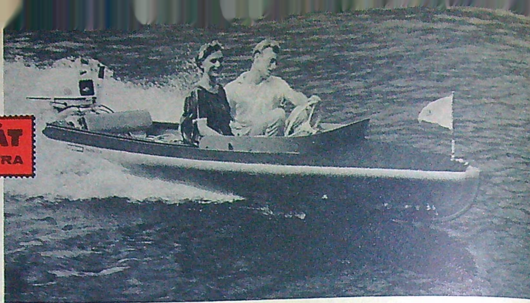
De tyska Klepper-båtarna består av ett skelett av trädelar och korrosionsfria metallbeslag, som kläds över med en specialbehandlad flerskiktad duk. Båtarna kan därför snabbt monteras upp och ner och kan i nedmonterat skick förvaras t.ex. i bagageutrymmet på en bil. Klepper Master är 3,60 m lång, 1,23 m bred och väger 49 kg samt är försedd med flyttankar. Den kan förses med utombordsmotorer på upp till 18 hk och kan användas som vattenski- och bogsereare. 1 400 kr.
