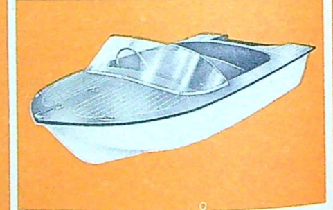
Cub 14 de Luxe är en plywoodbåt från Umeå Nya Skidfabrik, avsedd för 15-70 hk utombordsmotor. Färdig båt kostar 2 850 kr, byggsats 1 370 kr. Vikt 150 kg. Måtten på denna sportbåt är 4,25x1,80 m.
