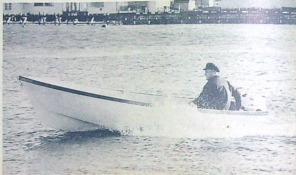
Roddåten Snurrån kommer från Malmö Flygindustri och skrovet är tillverkat av glasfiberplast. Båten är osänkbar genom inbyggda flyttankar som är så konstruerade att de även tjänstgör som bottenförstärkning. Snurrån har ritats av Olle Enderlein och dimensionerna är 4,25 m x 1,50 m. Båten väger ca 130 kg och kan lämpligen utrustas med utombordsmotor på mellan 3 och 8 hk. I första hand är båten tänkt som familjebåt för bad och fiske. Priset är 1 760 kronor.
