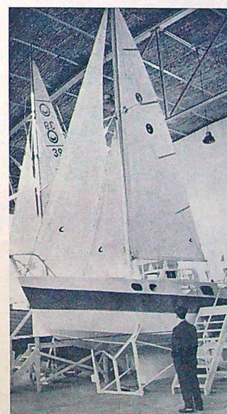
Lilla Harrie Verkstads AB har startat tillverkning av helsvetsade båtar i lättmetall. Serenad 77 är en midgethavskryssare som mäter 7,85 x 2,25 m och har en segelyta på 24 m 2 . Den är konstruerad av civilingenjör John Melchior. Pris med segel 29 400:—.
