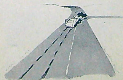
Se på bromsspåren! Hjulen har studsat och bara bromsat bilen korta sträckor.
