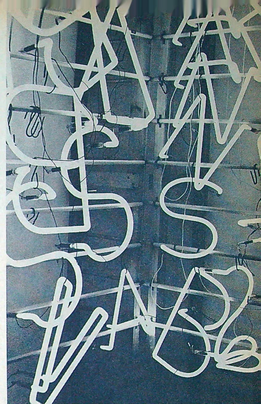
Nej, detta är ingen rebus. Bilden visar ett hörn av det moderna provrummet. Här kopplas rördetaljerna upp för provbränning innan de går till plåtelageri- verkstaden, där plåtunderlagen samtidigt tillverkas och där skyltarna monteras.
