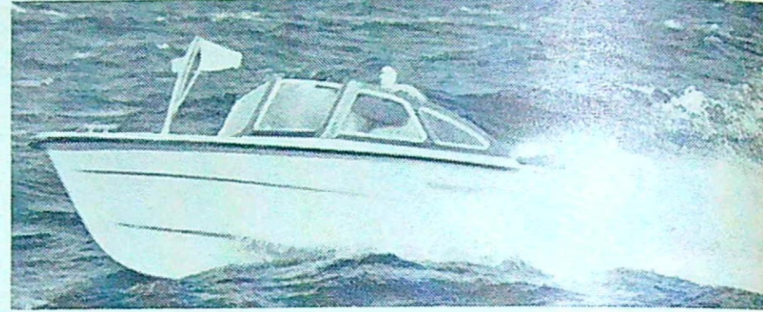
Monarks campingbåt är byggd i glasfiberplast och botten stegas upp av ett balksystem i plast. Konstruktör är Harry Becker och campingbåtens exteriör kännetecknas av steglignande skidlinjer, som gör båten stabil och goda sjöegenskaper i övrigt. Längden är 4,62 m, bredden 1,82 m. Komplet utrustad med ratt, el-installation med lanternor, ankare, dynor etc kostar båten 5 975:—.
