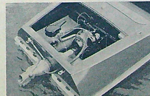
Den tyska firmen Waser tillverkar en båt med Wankelmotordrivet "vattenjetaggregat". Denna motor har en cylindervolym på 400 cc och ger 43 hk vid 6 000 v/min.
