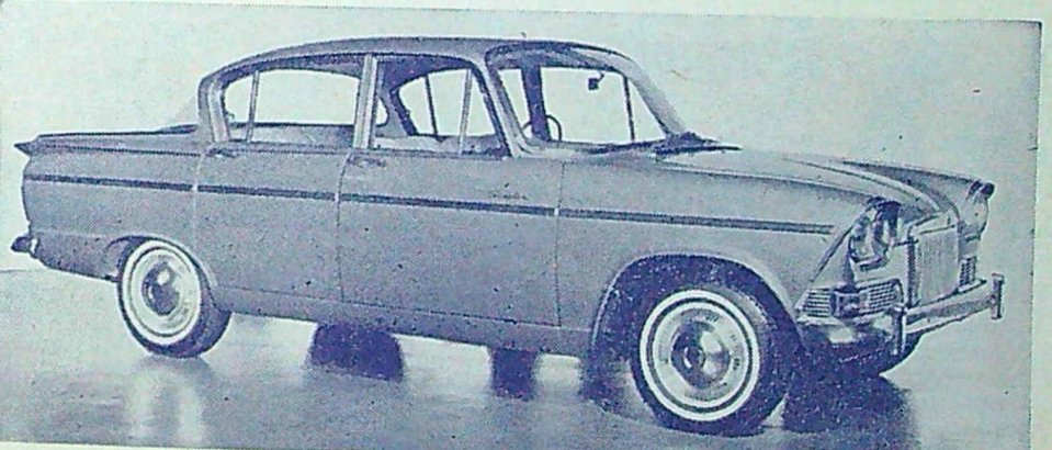
Rootes-koncernen presenterar en ny bilmodell med kompakta yttermått och fina prestanda. Vagnen, som kallas Humber Sceptre – Spiran – har Rootes' sportmotor på 1,6 liter som ger 86 SAE-hästar.
