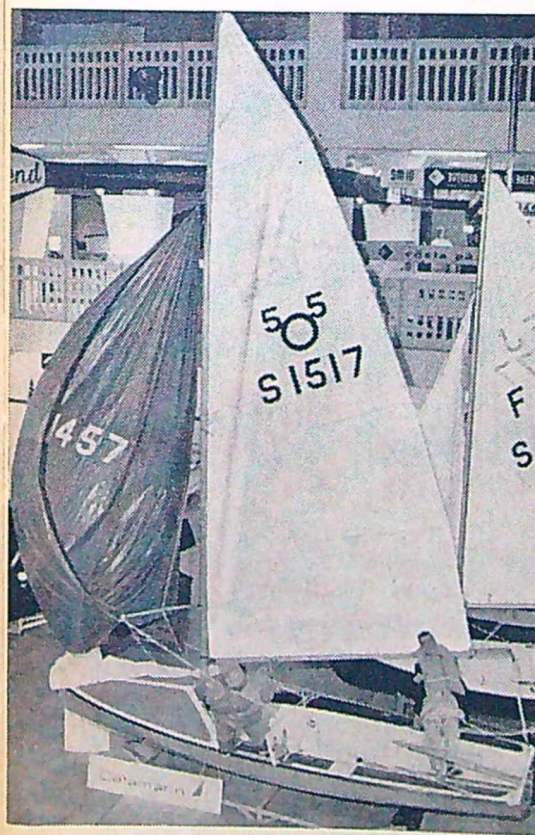
5-0-5 är en internationell två-mans centerbordsbåt som visat sig överlägset snabb och lättplanande i all slags vind och sjö. Glasfiberskrov. Måtten är 5,05 x 1,96 m. Segelytan är 16 m 2 var till kommer spinnaker. Priset är 6 456:—. Utställd av Catamarin.
