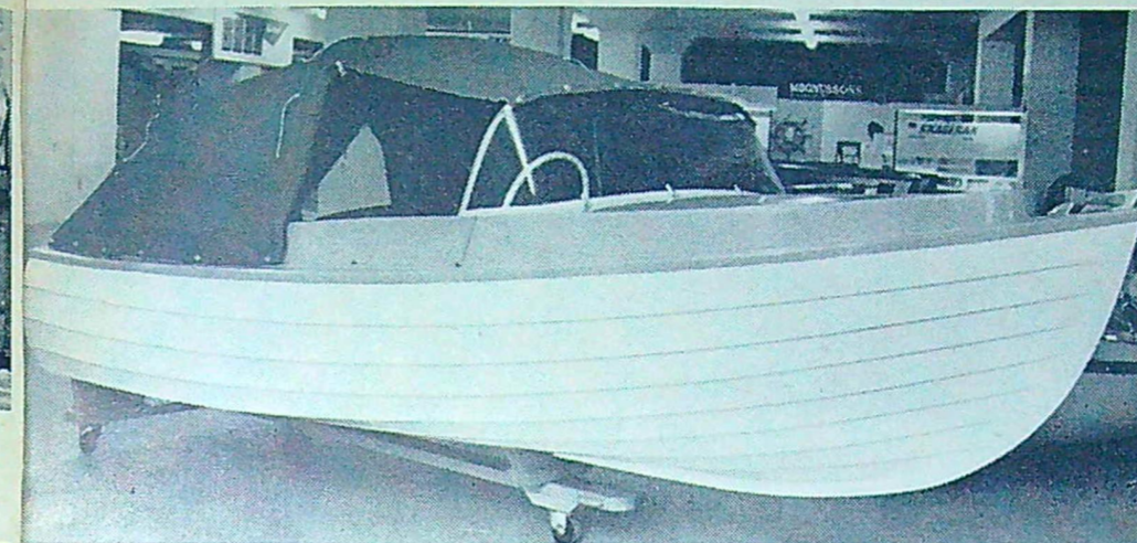
Frysator-Verken AB i Kungsbacka visade bl a ett par "klinkbyggda" båtar i glasfiberarmerad plast. Bilden visar Kingfisher, som mäter 4,85 x 1,85 m. Båten, som är avsedd för utombordsmotor, är halvöddad och har goda stuvningsutrymmen under fördaeket. Tofterna i sittrummet kan lätt tas bort och man får då en väl tilltagen sovplats på durken. Kingfisher är en ganska robust familjebåt, som närmast är avsedd för motorer i den lägre effektklassen, men det har dock visat sig att den kan pressas upp i över 20 knops fart om man föredrar en större motor. Båten kostar 3 950:—. Det finns också en helt öppen version av Kingfisher och priset för denna är 2 500:—. Om man så önskar kan man senare köpa fördaek till denna.
