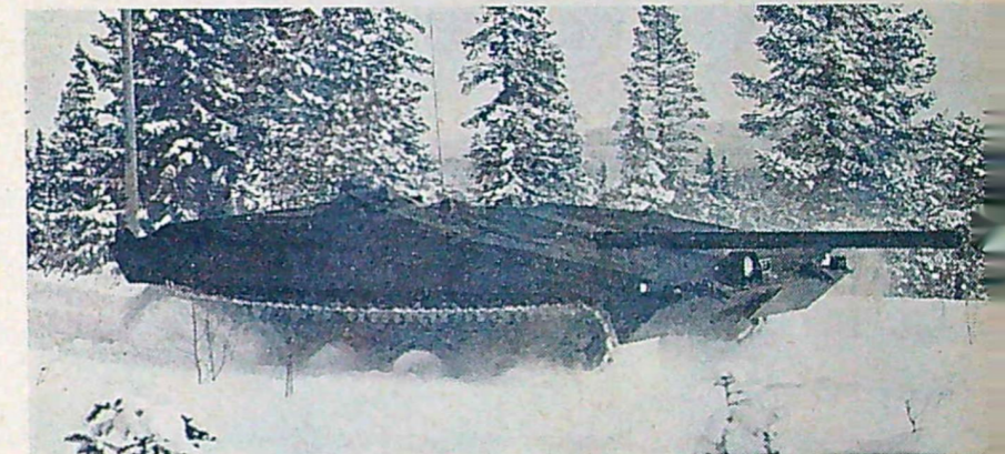
Den nya stridsvagn S är betydligt snabbare och rörligare än tidigare modeller. Föraren har allt som behövs, från styrning till radiopåslag, i ett enda manövreringsorgan.
