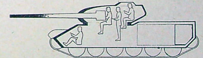
I dagens stridsvagn är stridsuppgifterna fördelade på fyra man, varav laddaren måste arbeta stående, vilket många gånger är mycket påfrestande.
