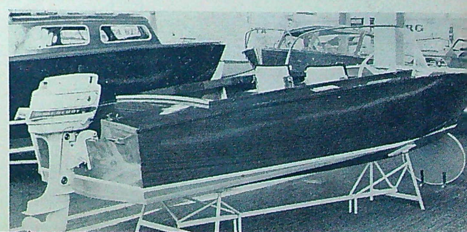
Överallt i landet byggs TfA:s läckra Sporty, som väckte stor uppmärksamhet på Marina Norrs monter på Allt för Sjön. Sporty är 4,5 m lång, 1,7 m bred och lämpar sig för motorer på mellan 25-60 hk. Sporty är ritad av Åke Sundstedt och materialet är mahognymarinplywood. Monteringsatsen, som kan rekvireras från TfA, kostar 1 095:—.
