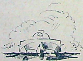
Lyths plastinombordare med måtten 4,4 x 1,65 m föreföll väl kort och propelleraxeln hade stark lutning. De långsgående tofflorna har använts med fördel på sportkatamaraner, men förskeppets stora bottenkropp verkar här störande. Ger stort friktionsmotstånd och försakar virvlar framför snurrn.
