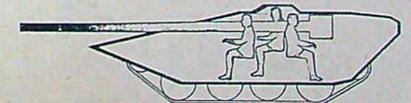
Fast kanon med automatisk laddning medger sittande besättning. Alla har observationsorgan på samma höjd. Lagg märke till den långa kanonpipan.
