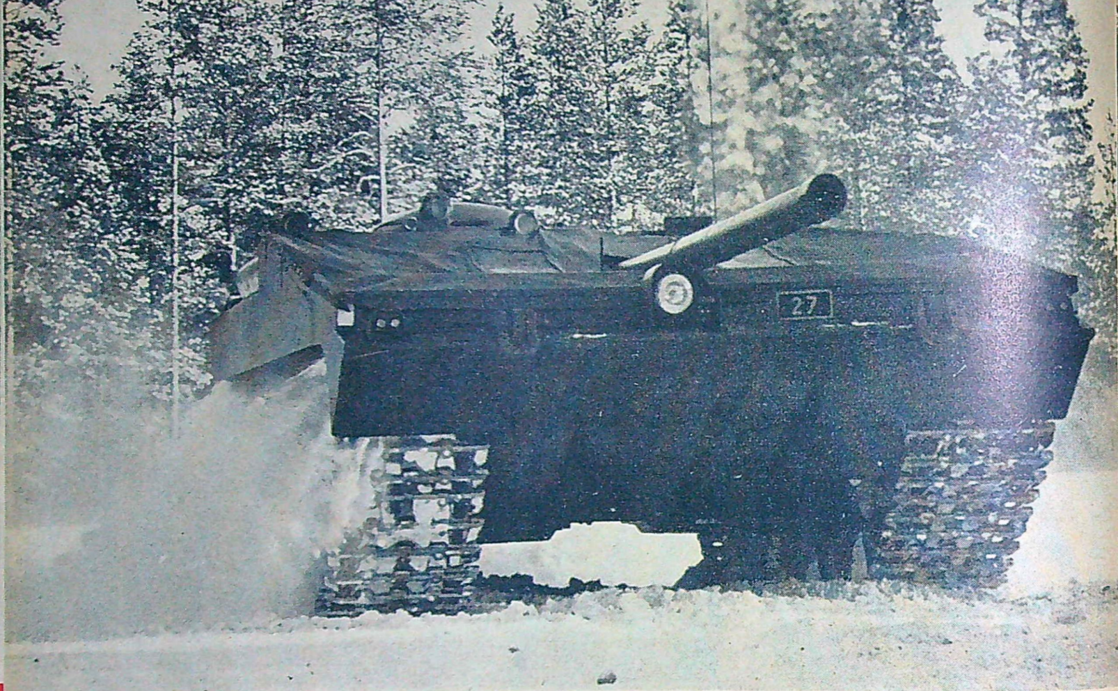
En av prototyperna till den nya svenska stridsvagnen med beteckningen S ses ovan på bilden. Lagg märke till att vagnen saknar torn och har fast kanon. En annan fördel är de breda banden som gör stridsvagn S lätt framkomlig även i djup snö.
