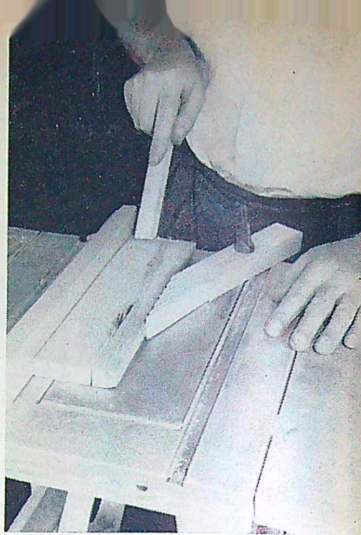
En hemgjord, fjädrande anordning används här för att hålla arbetsstycket mot klyvanhållet. För säkerhets skull matas arbetsstycket fram med en ribba.
