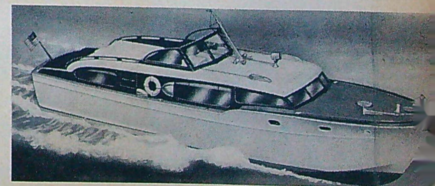
Chris Craft Corvette tillhör bjässarna i modellbåtsvärlden. Modellen är 120 cm lång och 35 cm bred. Byggsatsen, som tillverkas av Sterling, innehåller utstansade delar i balsa och plywood samt däck, överbyggnad och inredning i mahognyfaner. En eller två motorer kan installeras i denna jättemodell och den minsta motorstorlek som kan användas är 2,5 cc. Byggsatsen till Corvette kostar 179:—.
