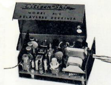
RL-6 MOTTAGARE 6-KANAL SELEKTIV SUPERHETERODYN HELTRANSISTORISERAD KRISTALLSTYRD RELÄLÖS — mottagare
