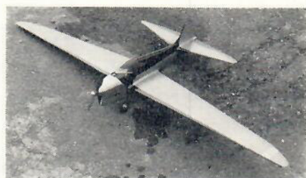
Arctic Circler i version II, Long John, gjorde mest nytta som experimentmodell med förlängt förgasarrör (första försöket till avstämning) och ökat sidoförhållande.
