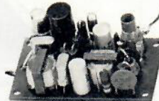
LT "3" MOTTAGARE 1-KANAL SUPERREGENERATIV Ton-Mottagare
