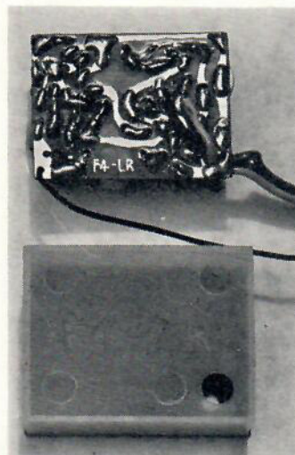
Futaba F4-LR uttagen ur plastlådan. Anslutningssladdarna och antennen är avlastade genom att före lödningen föras genom ett hål i kretsplattan.
