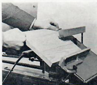
Fräsning av spår med snedställd klinga. Observera inlägget i sågbordet: För att ge plats för klingans rörelser i sidled används ett med extra bred öppning. (AEG).
