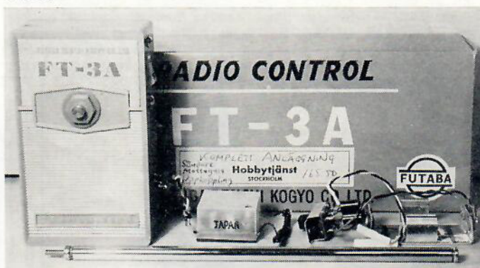
Ovan: Mottagaren levereras med trepolig anslutning som passar till den färdiga modellinstallationen, som medföljer den kompletta anläggningen. Nedan: Marknadens billigaste kompletta enkanals radioutrustning. Priset för anläggningen är lägre än enbart motorns till en tävlingsmodell i flerkanalssklassen.
