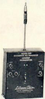
TMS SÄNDARE 10-KANAL HELTRANSISTORISERAD KRISTALLSTYRD MULTISIMULTAN Ton-Sändare
