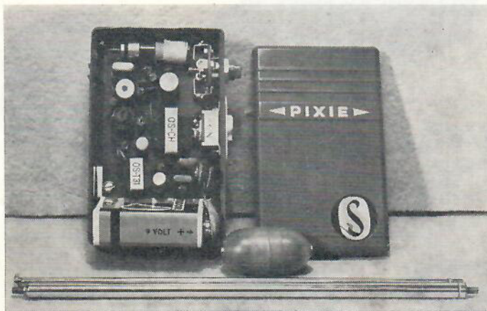
OS PIXIE sändare med locket avtaget. Anslutningen av 9 V batteriet syns tydligt, liksom den delade teleskopantennen med förlängningsspole. Det väl tilltagna utrymmet runt komponenterna underlättar felsökning och förhindrar onödig uppvärmning.
