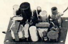
LT "3" MOTTAGARE 1-KANAL SUPERREGENERATIV Ton-Mottagare
