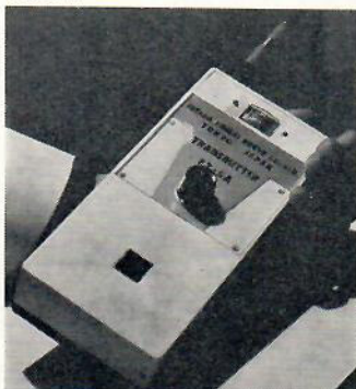
Sändaren FT5A. Antennens inbyggda förlängningsspole syns tydligt.
