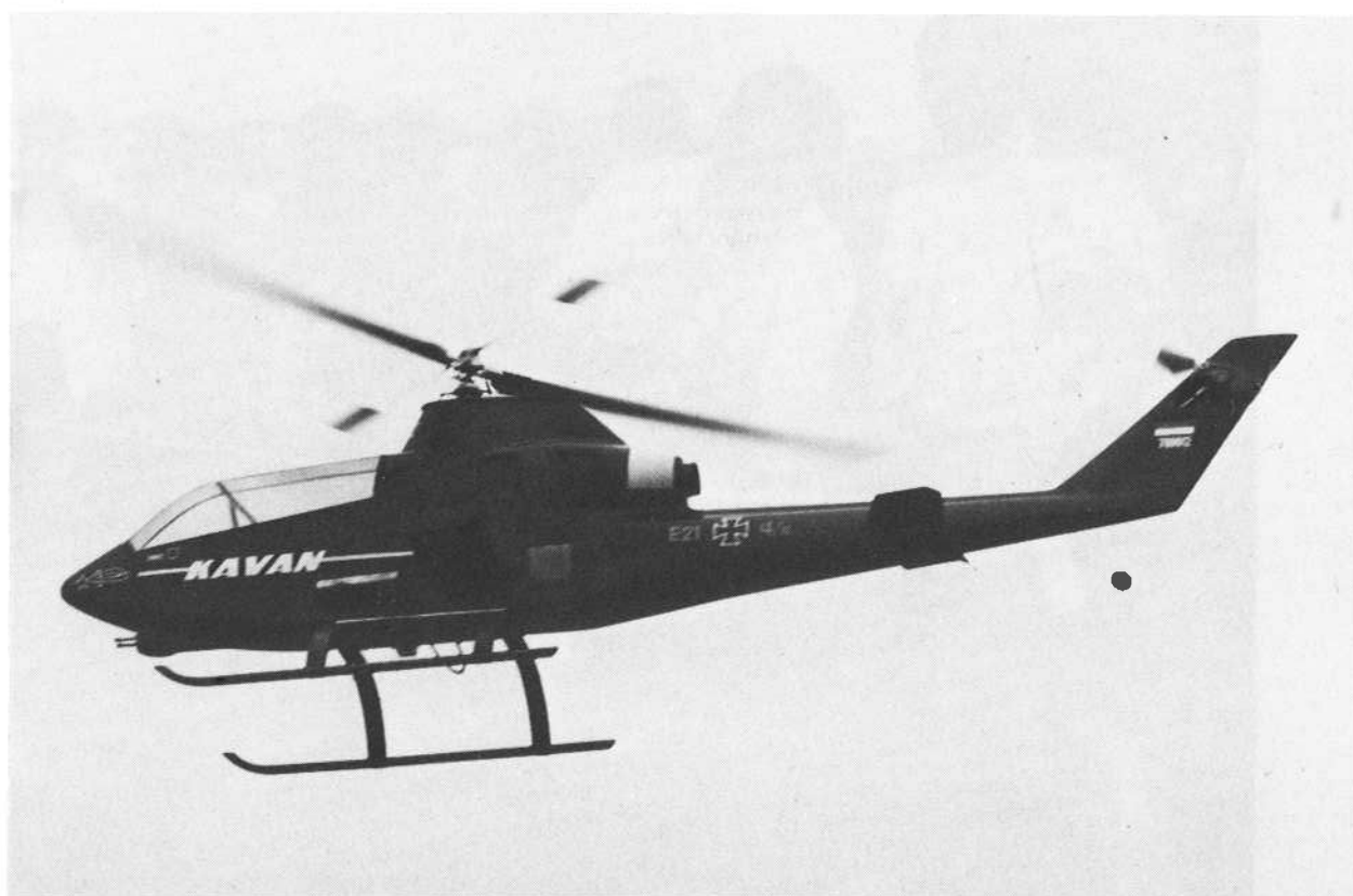
Helikoptern är en semiskalaversion av den amerikanska Bell Huey Cobra. Modellen ses här i en förbiflygning. Ovanför landställsskidan ses ljuddämparen utanpå kroppen, under nosensyns en av skaladetaljerna, ett litet kanontorn med två akan.
