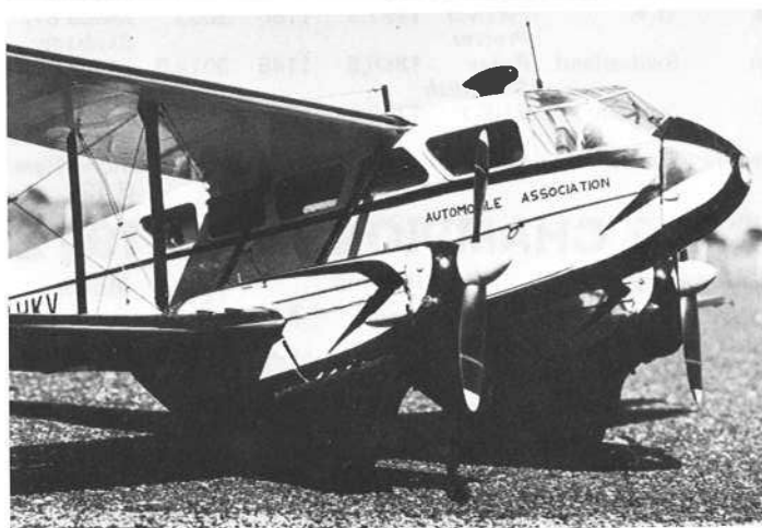
Se Havilland DH-89 "Dragon Rapide", Skala 1:10 av Jaques Matter, Frankrike. Linkontroll med 2 st OS-15. Här är det svårt att avgöra om detta är en modell!
