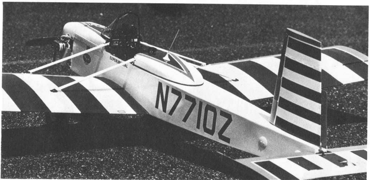
Evans "Volkspplane" VP i skala 1:4 av ett amerikanskt hemmabyggeflygplan. Modellen som mycket liknar en RC-1 modell har byggts av John Roth, USA. Observera dummytopparna på den tvåcylindriga Ross glödstitfsmotorn.
