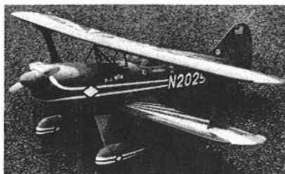
RC-Doppeldeckermodell 'Pitts Special', eine Spezialkonstruktion von Jerry Nelson USA; Spannweite 1220 mm
