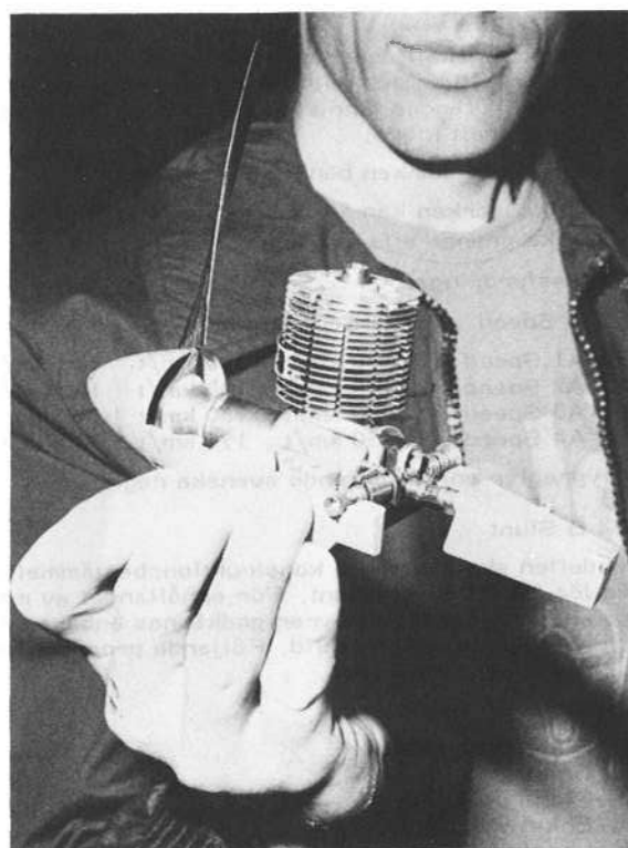
... Avgasportar framåt, frontbox av stål, tunn, bred och lång propeller med ett blad och motvikt av tungmetall i splnneren, ... Foto: Sven Pontan
