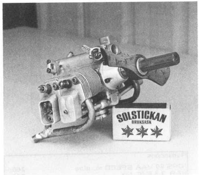
Ventilhusen helt inbyggda.
