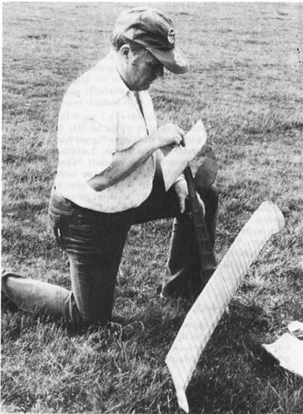
Arne Berglin, Östersund ordnar en fuse på "Skyway" -en "S-int"-modell. Obs! fenan man får ibland ändra litet för att bygga in termikbroms i gamla modeller. Foto: S-O Lindén
