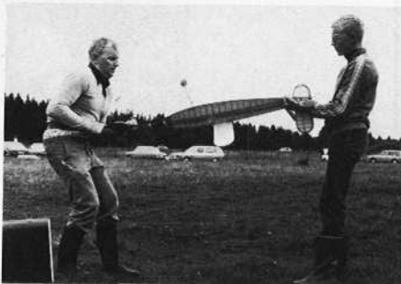
Wakefield-vinnaren Einar Håkansson får hjälp av sonen då han drar upp gummitorn på sin "Ellilä". OBS! Två motorer, överföring med kugghjul i aktern, s k krax.
