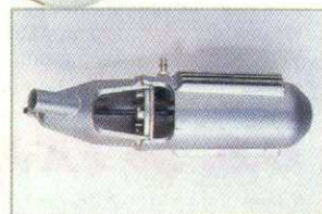
Nykonstruerad dämpare med extra mellanvägg för tystaregång.
