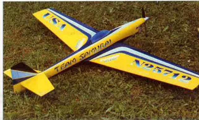
Manfred Picks nya Dago Red. Skilnaderna mot den gamla är de uppåtvinklade vingspetsarna, smalare bakkropp samt högre och smalare form på fenan. Notera insuget till en frontmatad IR. T.h.: Veranos modell.
