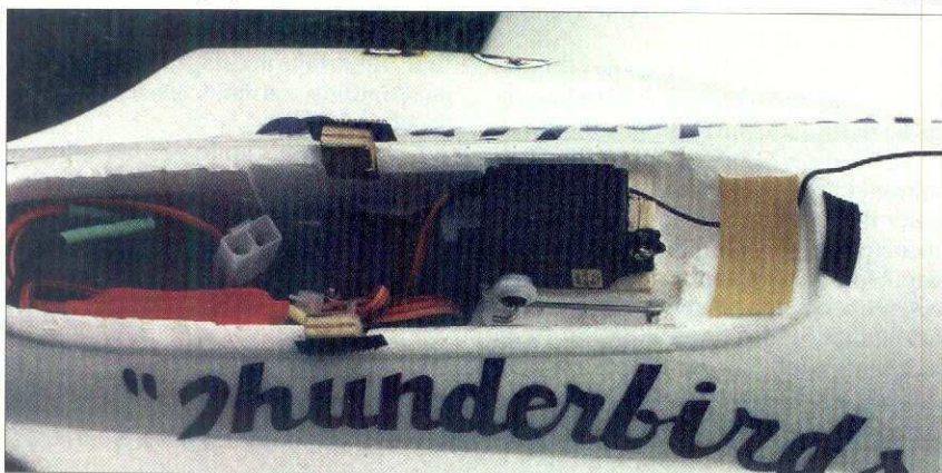
Radioutrymmet med höjdroderservot och fartreglaget synliga
