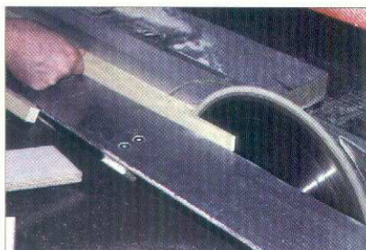
Urtag för fena och stabilisator sågas.
