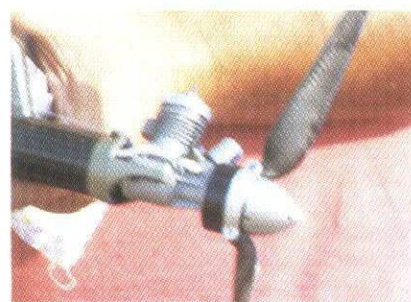
Motor försedd med planetväxel som gör att en stor propeller med större verkningsgrad kan användas. Modellen en F1J 1 cc motor, konstruktör Maksimov, Ukraina
