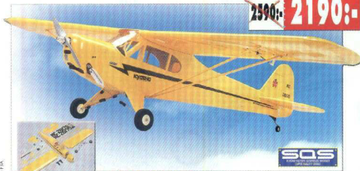
PIPER J-3 CUB 4C-50/40 Längd: 1150 mm Spännvidd: 1820 mm Vingprofil: NACA2415 Vingyta: 49 dm Vikt: 2.500 g
