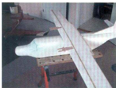
Provmontage före klädsel, notera vingbalken.
