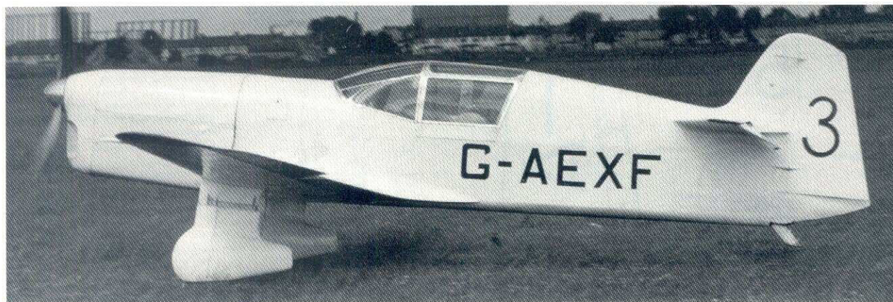
EXF 1937, med Gipsy Six series II - motorn och D.H. constant speed propeller. Tävlingsnummer 3 avser Isle of Man detta år. Bilden från Flight Int.
