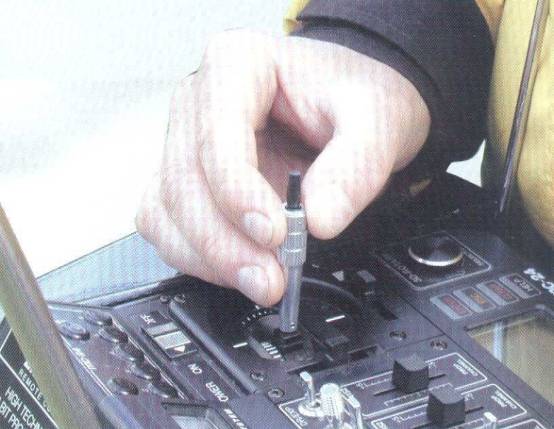
Joakim Ståhl demonstrerar styrningsmetoden han alltid haft. Med den extra switchen i styrspaken kan han snabbt växla mellan olika klafflägen.
