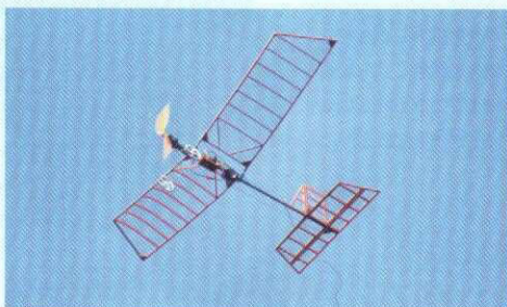
Modellen som kallas "Stickan" är byggd av Björn Ekström i Hyltebruk. Stickan väger 170 gram flygklar. Spännvidd: 1.000 mm, motor: GWS med växel 5:1, propeller: 10-4,7, klädsel: 7-grams mylar.
