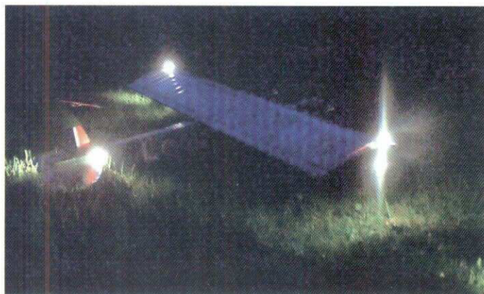
Hedströms "LOUD". Här syns tydligt placeringen av lamporna för att man ska kunna se minst tre ljuspunkter oberoende av hur modellen vänder. Lamporna på vingarna bör placeras så långt ut det bara går, då får man bäst feedback i rollplanet.
