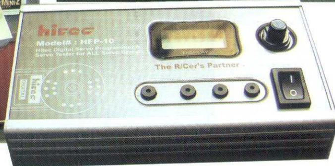
Hitec HFP-10 som testar mottagare och programmerar digitala servon.
