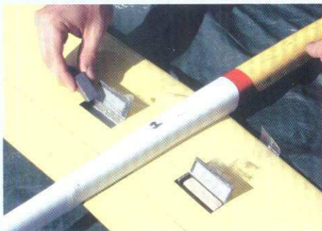
F3B-kärror har en inbyggd kanal för blyvikter. De läggs in före distans- och speedmomenten.
