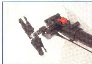
Stjärtrotormekanik hämtad från Raptor 60 för maximal styrka och precision!
