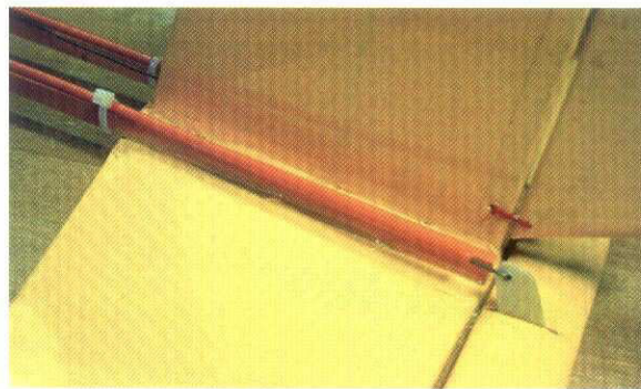
Roderhorn av nylon blir klumpigt – gör helst egna av trekantiga plywoodbitar som CA-limmas i en skära i roderet.
