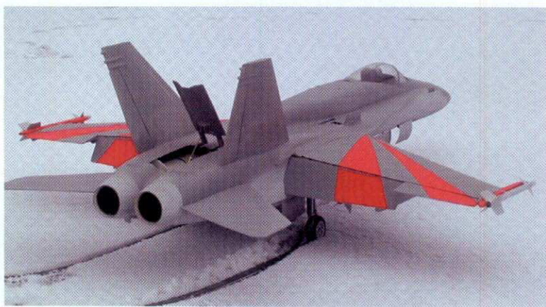
F/A 18 Hornet med full klaff maximal luftbroms uppfäld.
