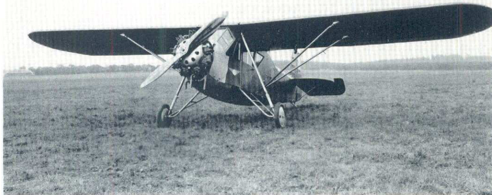
Viking I med mod 9-cylindrig stjärnmotor, Walter Mars på 145 hk
