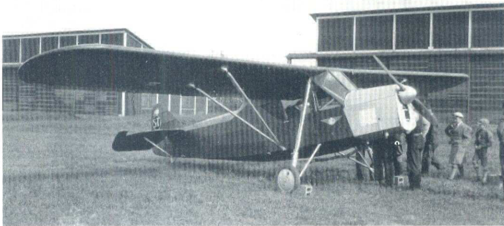
"Viking I" under motorkörning på Malmen före första flygning. Den enkla frontplåten byttes sedan till en något rundad. Tv: I luften med flottörerna på.
