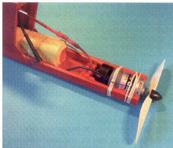
Motorn fästs med små gummiband för att lätt kunna bytas och för att lossna vid en markkontakt (som det så vackert heter Ö.) Väg av till rätt tyngdpunkt genom att flytta acken framåt eller bakåt.
