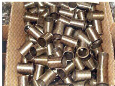
En hel hög med stålfoder. Det går åt fyra stycken per motor
