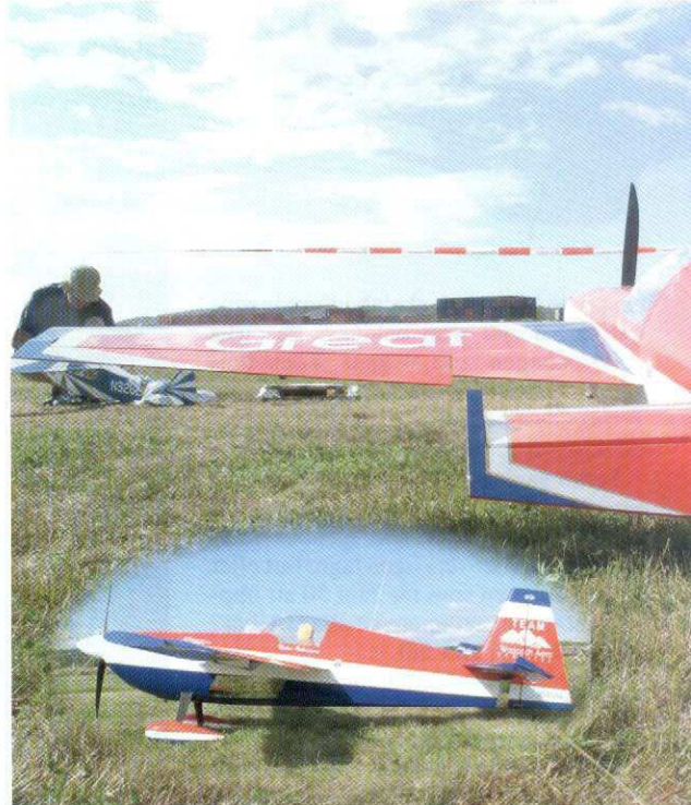
Nicklas Robertsson har gjort det igen. Edge 540 vakuumbakat i glas, kolfiber och kevlar. Modellen är något större än Cap 231ex för att motorn skall få plats i motorkåpan. 2-sitsig Edge
