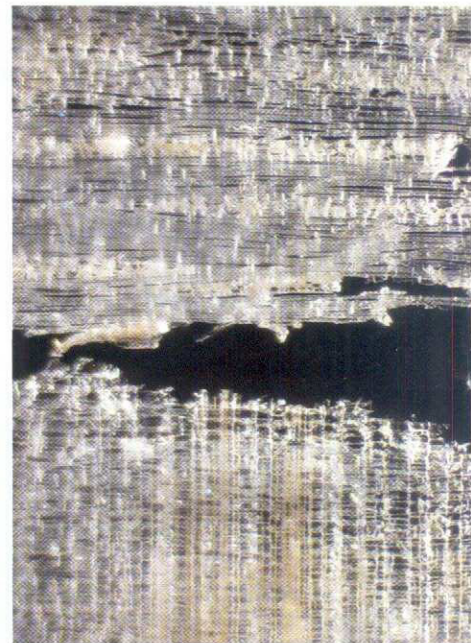
Hyvelspån av balsa sedda i mikroskop. Överst A-grain och underst C-grain. Fiberriktningen är från höger till vänster. De gulbruna partierna är mörkstrålarna som i A-grain går rakt in
