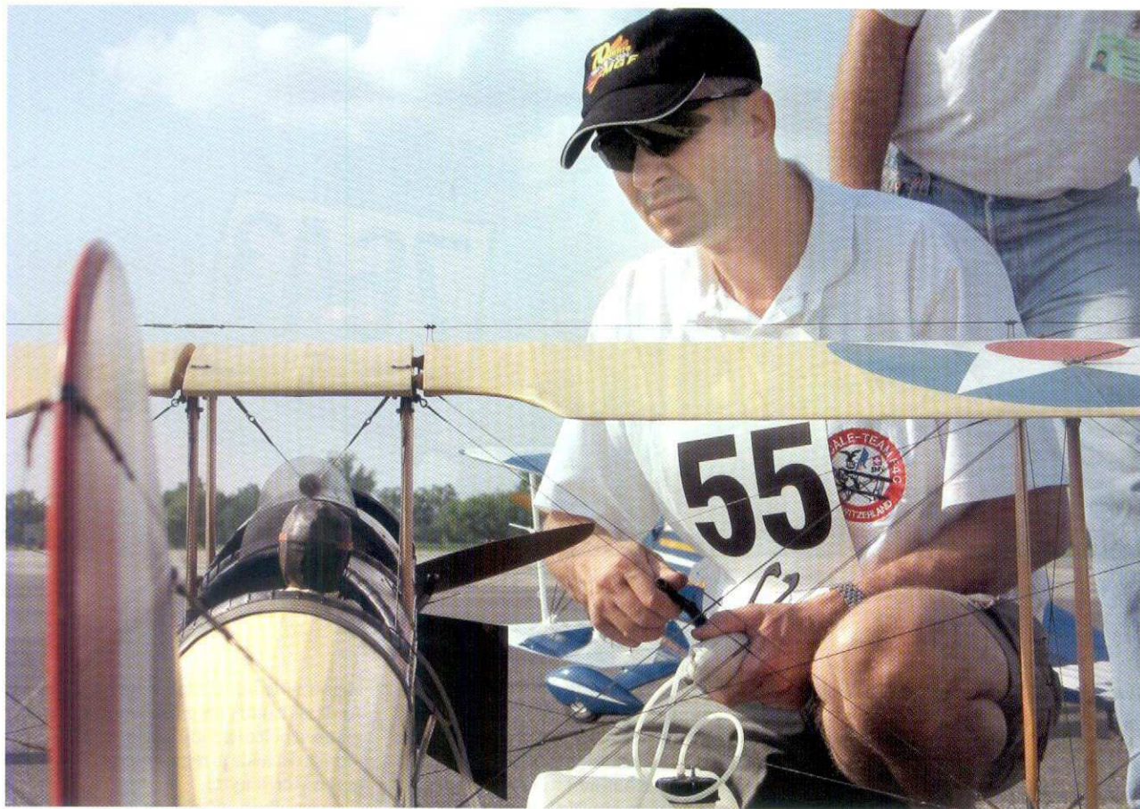
Hans Ammans Curtiss Jenny har en motor kallad Primax, 2-cyl radmotor med en tomgång lägre än allt annat på ca 1000 rpm.
