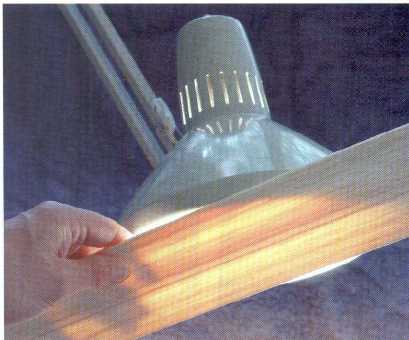
Med en lampa kan man se tyngre och lättare partier i ett balsaflak - röntgentricket.
