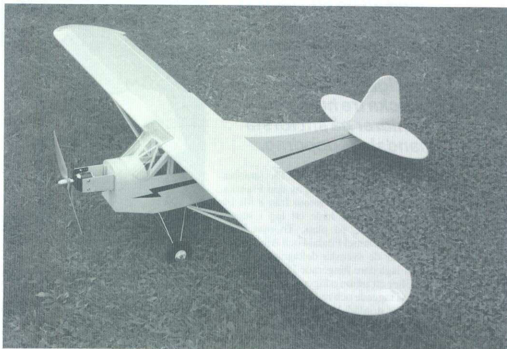
Kyosho Cub 40 konverterad till eldrift. 490 watt i en modell på 2,5 kg är helt lagom (196 W/kg). Flygtiden med LiPo-paketet är drygt 25 min. Lithium Polymererna har sannerligen tagit död på åsikten att en elkonverterad modell blir en tung modell.
