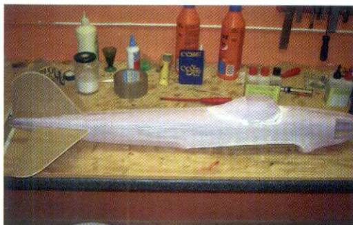
Kroppen tar form. Tapetremorna i glasfiber är en perfekt förstärkning.
