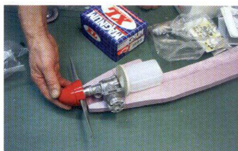
Motorspantet ska på plats. Vi använder plywood som vi hittade på jobbet. Det hade använts som emballage till en maskin. Man tager vad man haver!
