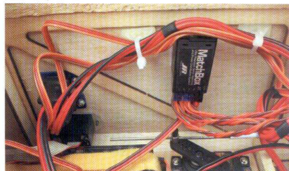
Om man styr två eller flera servon från samma kanal är en Matchbox viktig. Den synkroniserar servonas rörelse så de jobbar effektivt i par. Lägg också märke till hur kablarna är snyggt sammanbundna med tape och buntband till kabelstammar.
