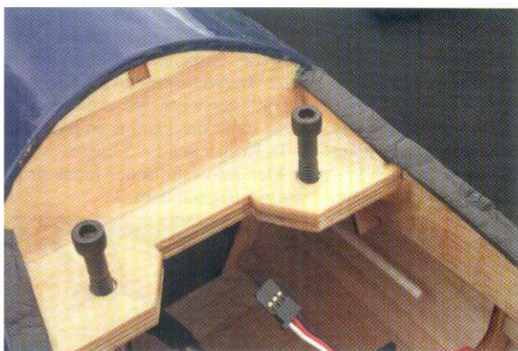
Nylonbultar ersätts oftast med metallbultar vid vingfastsättningen. Kolla bara att det finns tillräckligt stora bickor som fördelar trycket av bultens huvud.
