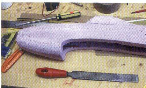
Rasp och framförallt surfer är ovärderliga redskap när man bygger med ECOPRIM – rosa frigolit eller foam som det också kallas.
