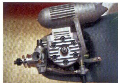
Motorinstallationen är inga konstigheter precis. Motorn skruvas fast med träskruv.
