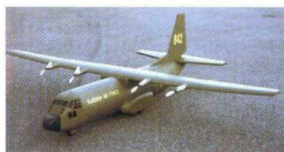
En ganska stor modell av denna typ, helt i frigolit, är relativt ofarlig. Här finns heller ingen stor motor, spinner eller stor propeller och hastigheten är måttlig.
