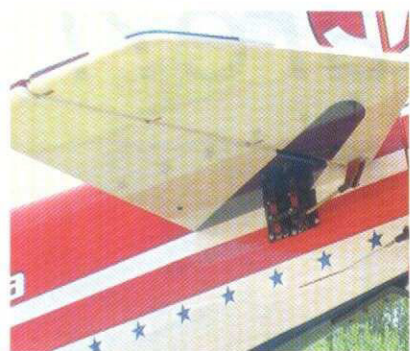
Under stabilisatorn sitter två servon som gemensamt styr höjdroret via en enda stötdång.
