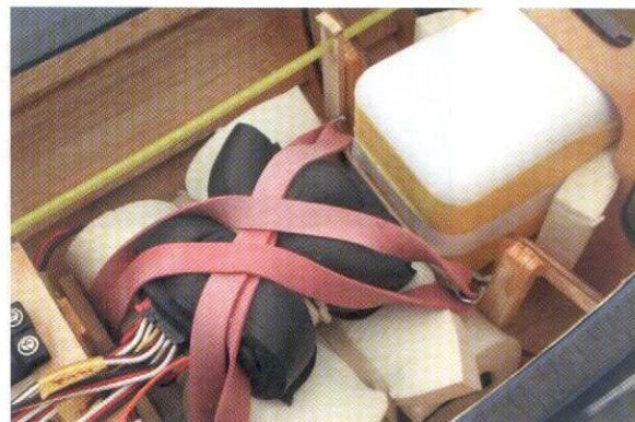
Exempel på en mycket stabil ackfastsättning som också är effektivt avvibrerad!
