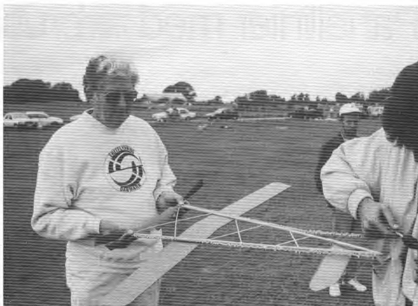
Erik Knudsen assisterer ved optrækket af en »twin pusher« model. Typen er fra omkring 1910 og forsynet med to modsatrotterende, skubbende propeller. Den flyver med »halen« forrest og er altså en såkaldt andemodell.
