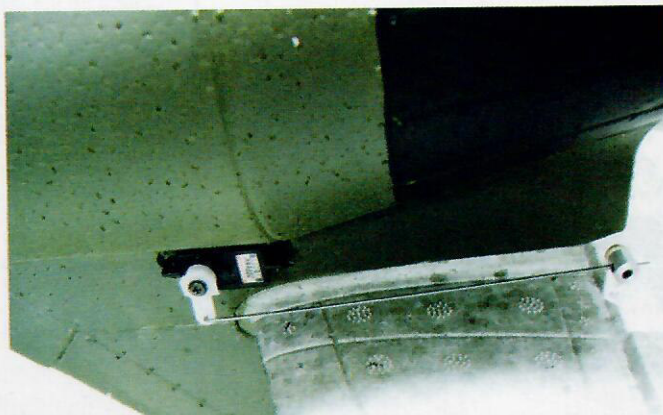
Hitec HS65 och linkage till höjrodet
