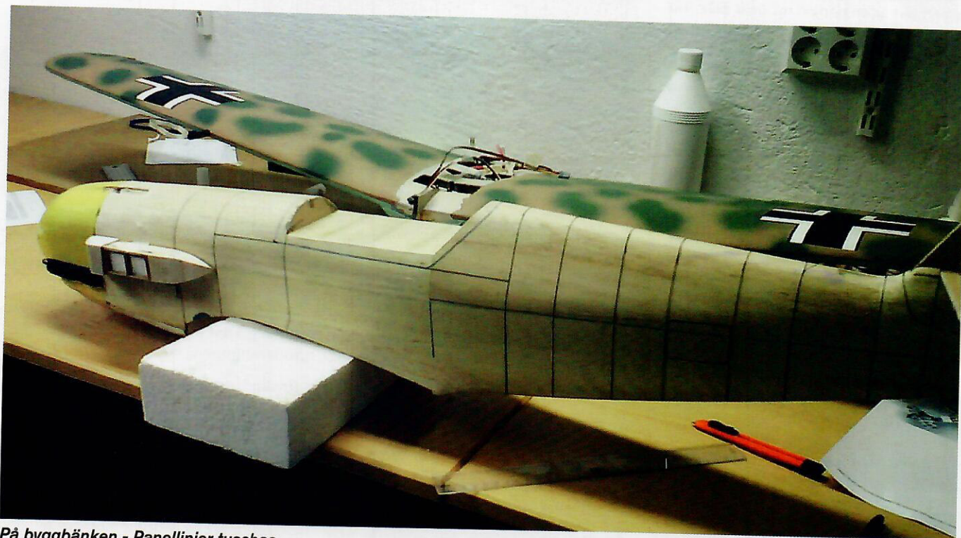
På byggbänken - Panellinjer tuschas.
