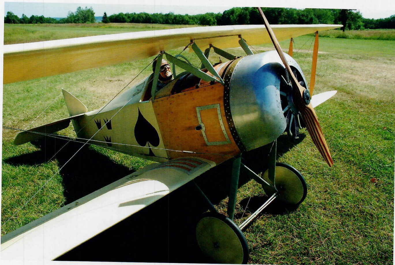
Radialmotorn, av typ Thulin A, hade nio cylindrar och gav 90 hästar.
