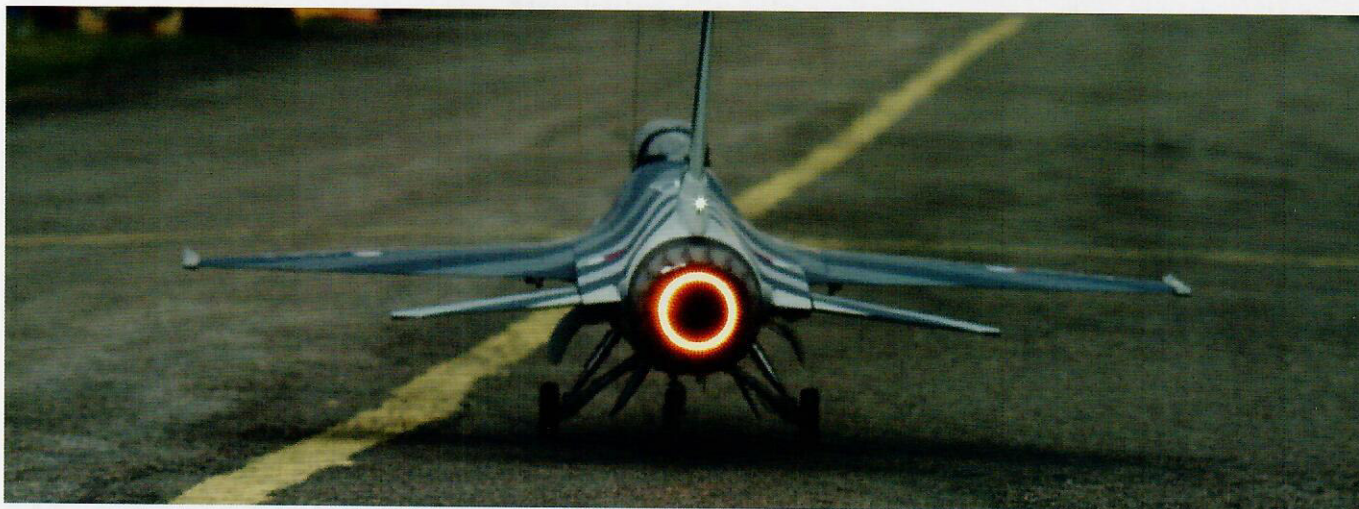
Lysring (ledlampor) kopplad via ECU som är kopplade via trotteln kanalen så att det ska se ut som en EBK otroligt effektivt.
