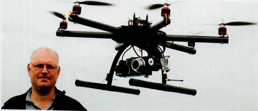
Tomas Olsson uppvisningsflög en fotoplattform kallad Mikrokopter med servostabiliserad kamera. Med den kan piloten fotografera landskap, hus, inspektera vindkraftverk och så vidare.
