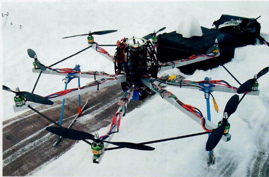
Ulf Grünbaums oktakopter. I centrum ett antal kretskort med sensorer, attityd-kontroll och navigationsenhet. Liten, lätt och avancerad. Tillverkare: MikroKopter
