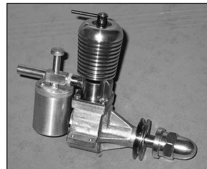
Kjell Lindqvist i Alingsås tillverkar modellmotorer i högre takt än vi andra bygger modeller! Denna gång visar vi hans Sparey 5 cc diesel, som han byggt i två exemplar denna vinter efter ritning i Aeromodeller May 1946. Den finns även i en 0.6-cc-version och Sparey's dieslar lär ha varit de första av sitt slag i England.
