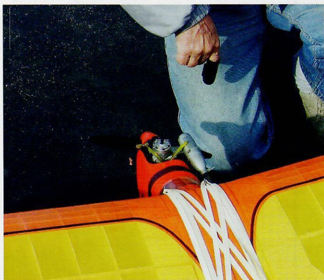
Det sitter en Irvine diesel på 3,5 kubik i nosen på kärran. Den ger modellen en lagom fart men räcker även till att dra runt Cloud Cruisern i en looping eller roll.
