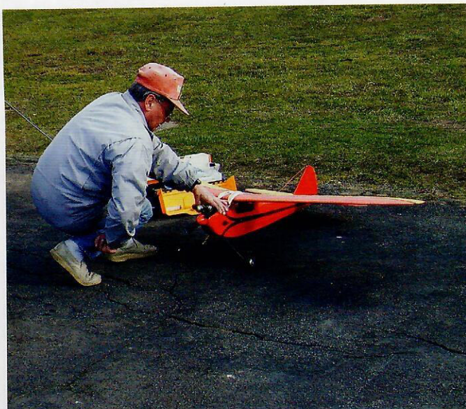
Göran skall till att starta. En diesel kan bita till bra med sin höga kompression så det är vist att ha en gummitutt på fingret.
