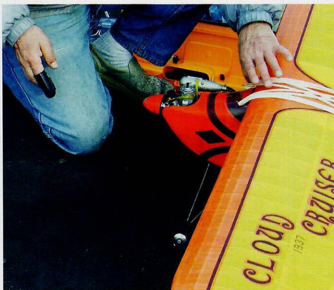
Det sitter en Irvine diesel på 3,5 kubik i nosen på kärran. Den ger modellen en lagom fart men räcker även till att dra runt Cloud Cruisern i en looping eller roll.
