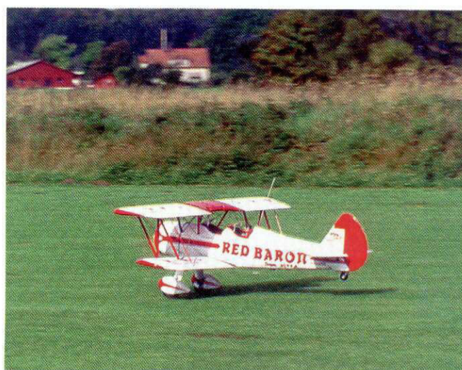
Modellen startar. De dubbla vingarna gör att bärytan är stor och det behövs eftersom modellen väger hela 12 kilo.
