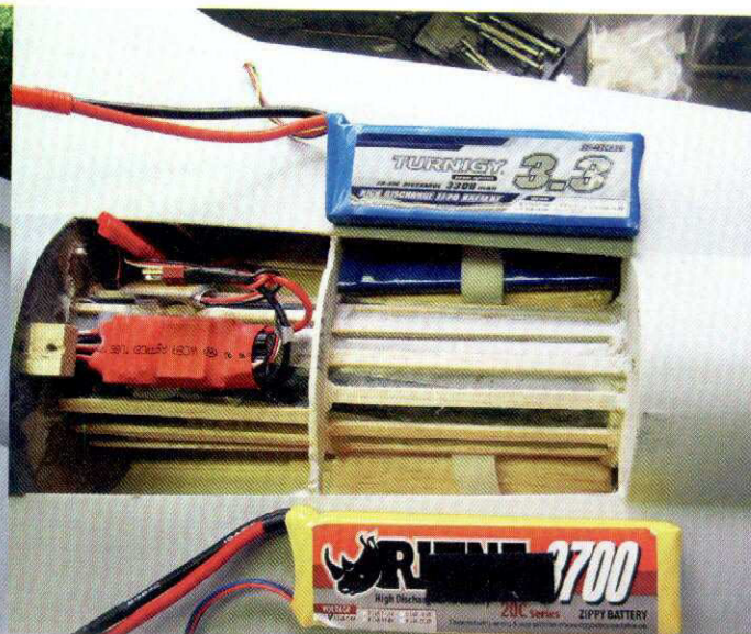
Lipo av olika kapacitet. Fartreglage och UBEC.
