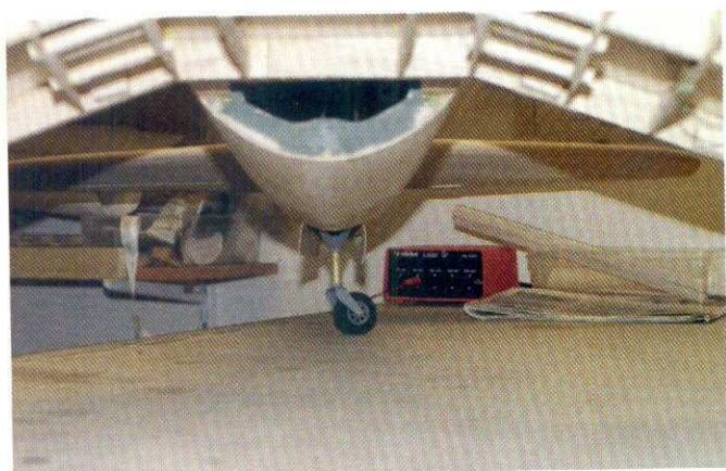
Provat luckarna. Det skall passas in i hålet för sporrhjulet.
