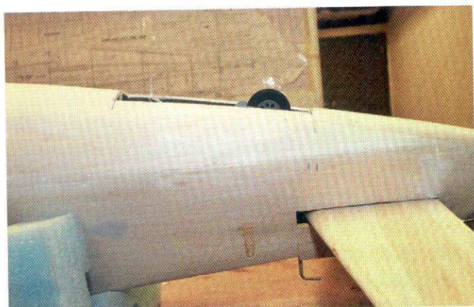
Så skall sporrhjulet se ut när den är infälld.
