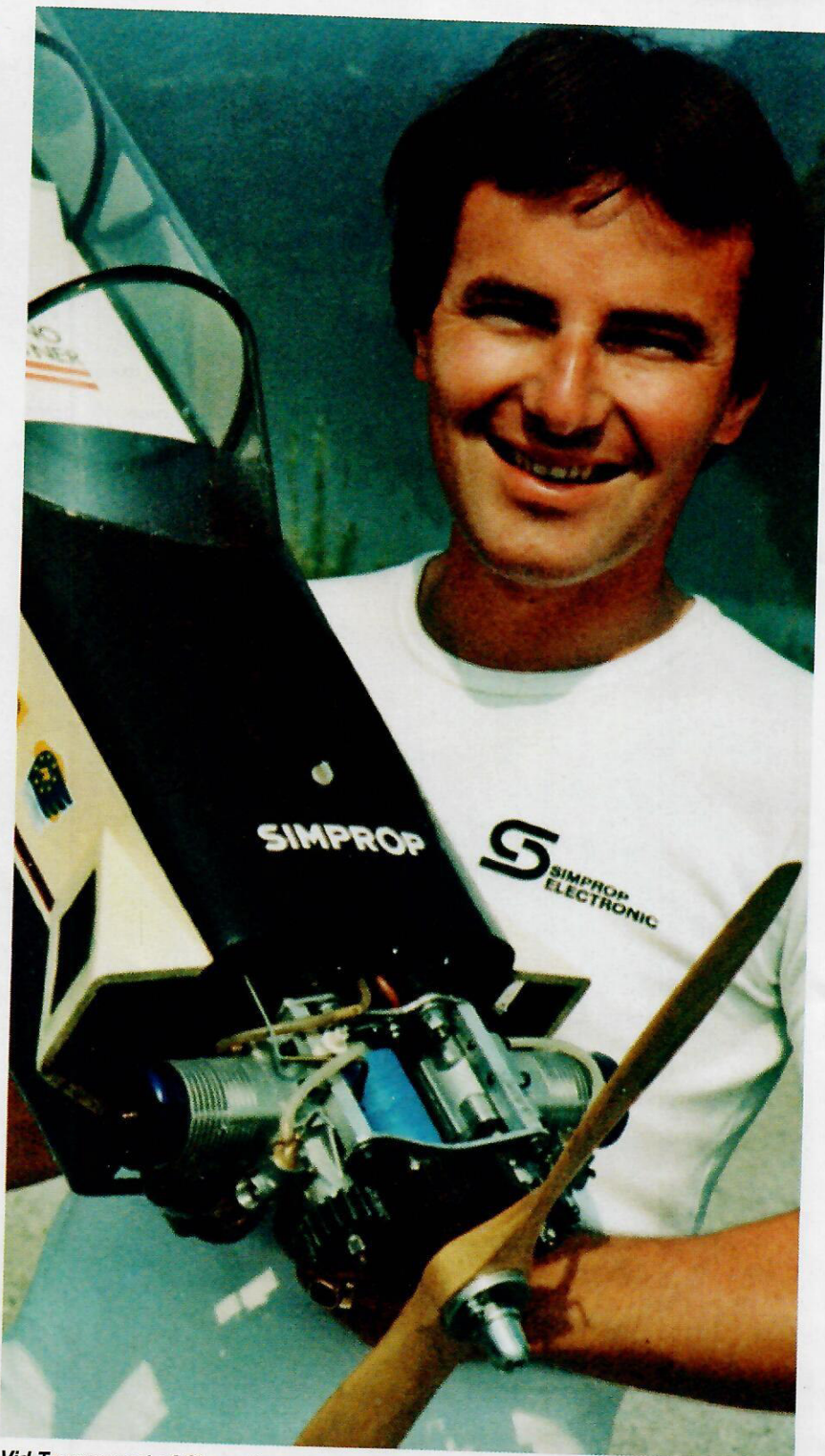
Vid Tournament of Champions 1980 använde Hanno två växlade Super Tigre 60X i nosen på tävlingsmodellen.
