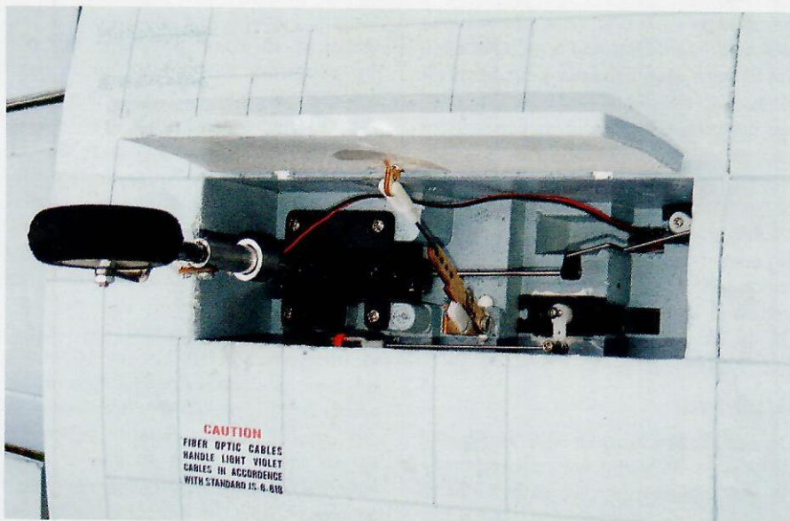
Nosstället förlängde jag för att få upp nosen i starten. Det blev väldigt lyckat.
