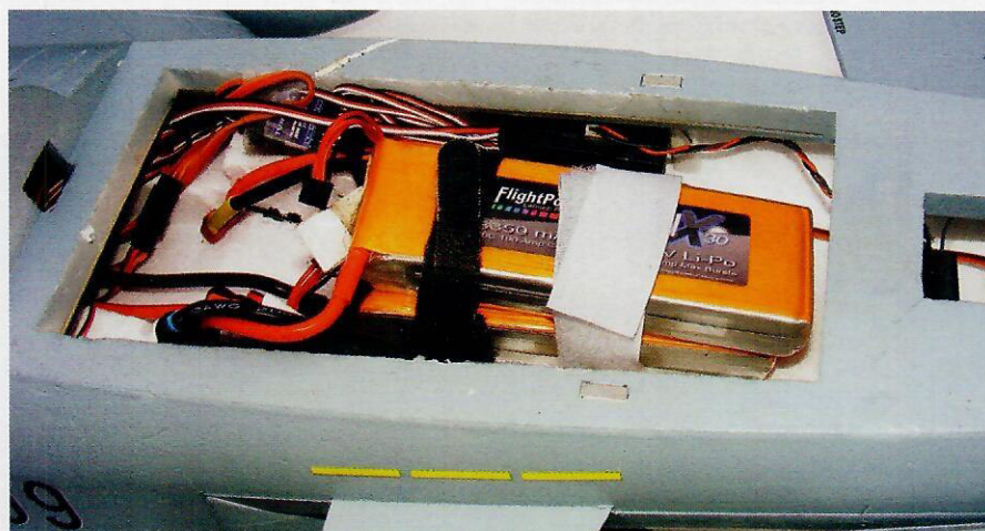
Två högeffektiva 3S paket i serie på 3500 mah. Perfekt för gräsfältet då man vill ha låg vikt.
