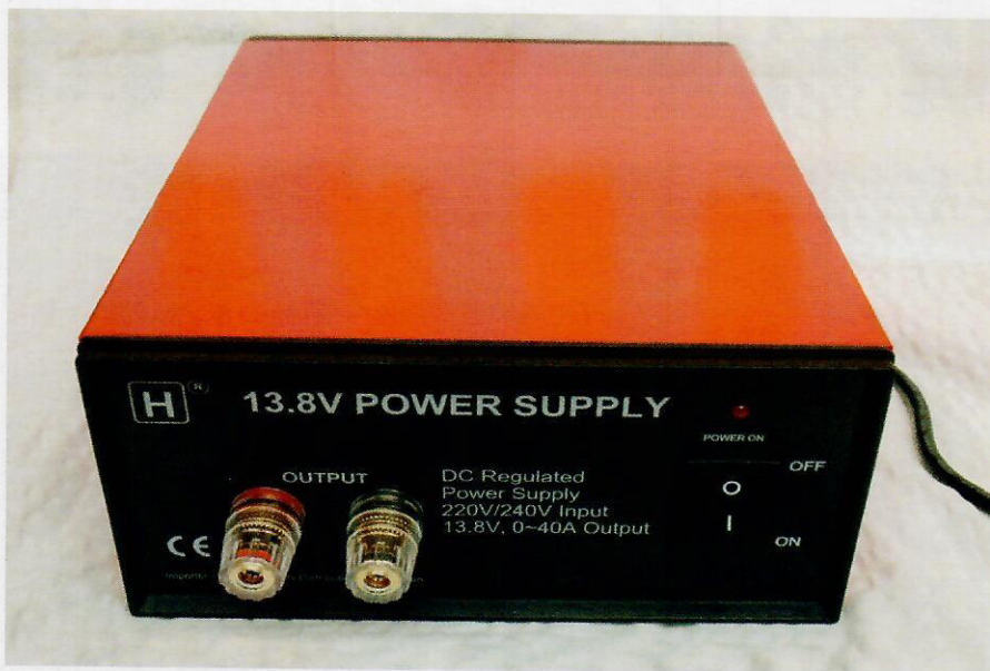
Nätaggregatet H W 1200R på 40A ger 13,8 Volt konstant ström.
