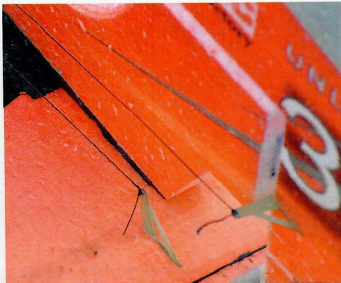
Se till att höjd- och sidorodrens horn inte kolliderar vid stora utslag...
