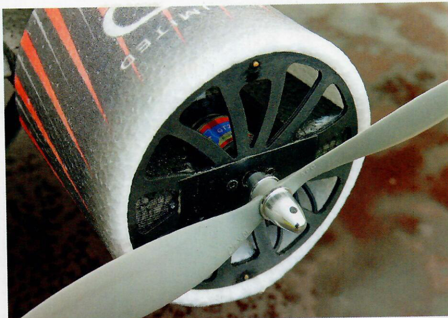
Lägg märke till den rektangulära glasfiberförstärkningen. (extra tillbehör)
