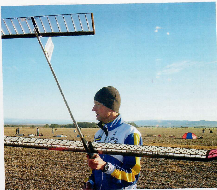
Robban med Pelles flappermodell. Notera den komplexa uppbyggnaden av vingen. Det behövs för att få tillräcklig styvhet. (Foto: Gunnar Wivardsson)
