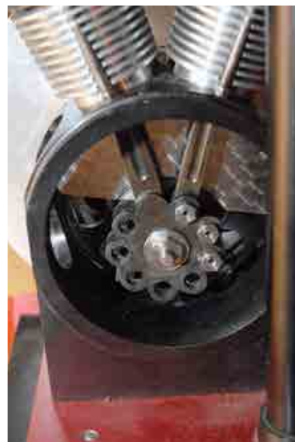
Två cylindrar med huvudvevstaken samt slavstake i en vevhusmuockup.
