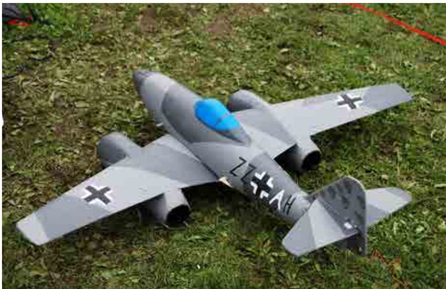
Det går även att tävla med EDF-modeller i Aircombat. På bilden ser vi Denny Fritsches ME262 med två EFD som drivkälla.
