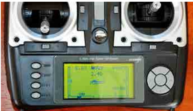
Här framgår att batterierna är på 5,6 volt, modell ett är vald (i mitten nere i fönstret) och att sidorodret är något trimmat. Lägg märke till knapparna till vänster: MENU, EXIT samt + och -.
