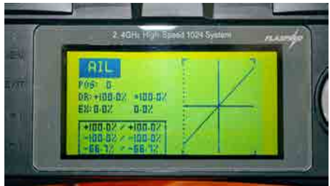
Här är skevrodden i ett ursprungsläge. Siffrorna är noll och grafiken lutar i 45 grader.
