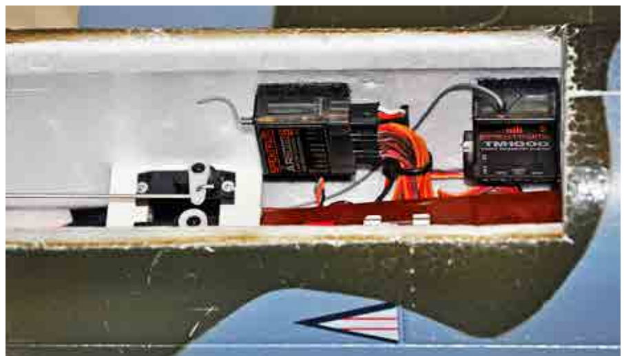
Radio och telemetri på kabinväggen.
