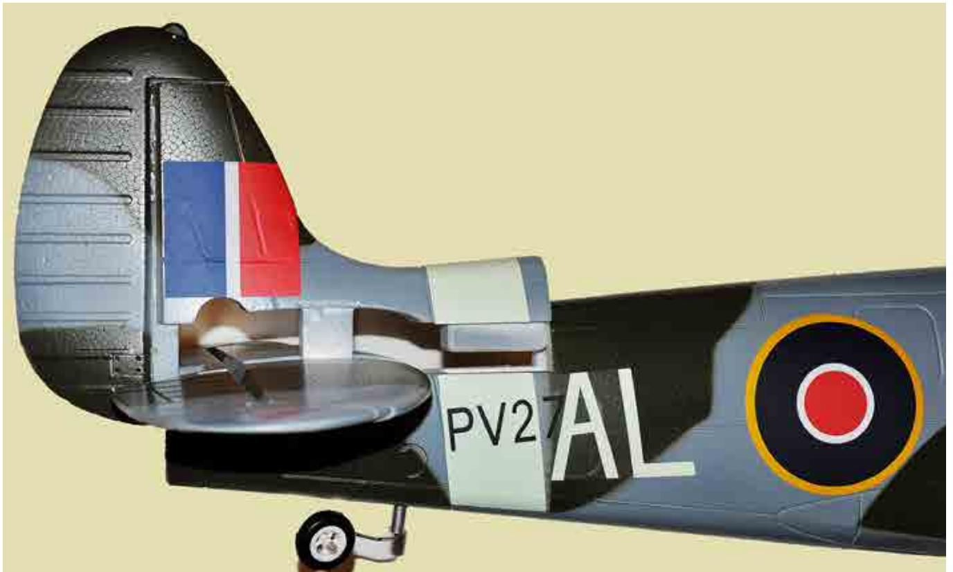
Fenan fästs med tre kraftiga tappar som trycks ner i kroppen.
